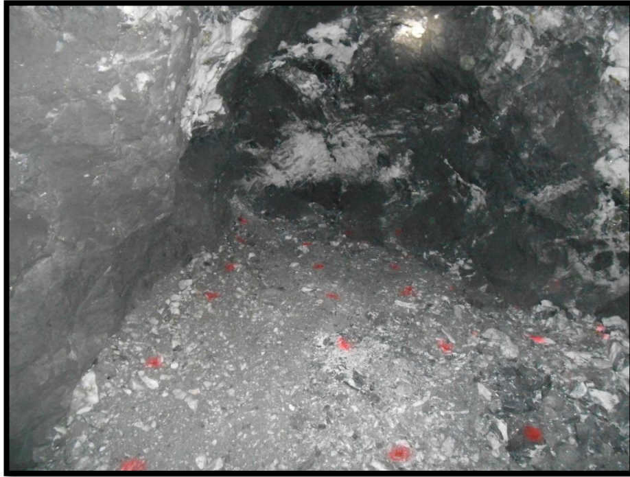
Figura 52. Grab Sample sobre frente de explotación Cruce 7 Norte (nótese la malla de puntos distribuida a lo largo del material extraído).
