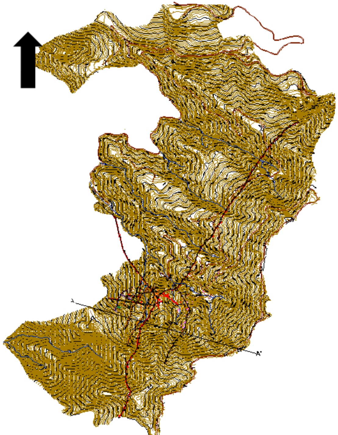
Figura 45. Plano mina El Gran Porvenir en planta señalando la dirección del corte A-A; En color rojo: guías, café: curvas de nivel, azul: drenajes.
