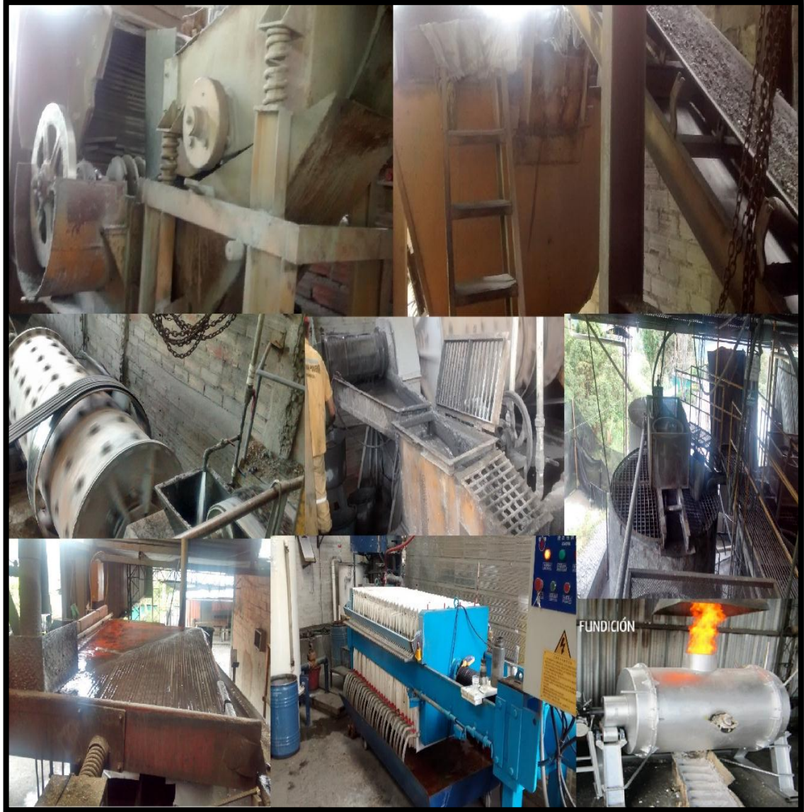
Figura 32. Circuito planta de beneficio mina El Gran Porvenir. En esta imagen de izquierda a derecha parte superior, se observa Trituración, Molienda, Concentración en la JIG, Cianuración, Merrill Crowe y Fundición.
