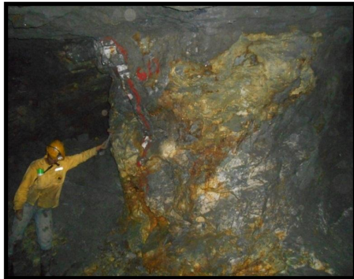
Figura 23. Pilar de sostenimiento en el método de cámaras y pilares, nótese el espesor de la veta y el tamaño del pilar. Guía 3 Sur; mina Gran Porvenir del Líbano.
