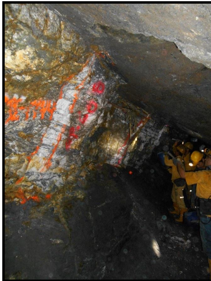
Figura 55. Muestreo sistemático en guías cada 2 metros sobre veta de qzo; Cruce 3 interno Mina Gran Porvenir.
