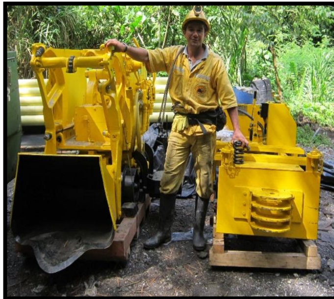
Figura 30. Pala Neumática (izquierda de la imagen), utilizada en las labores de descargue de Frentes mineros en la Mina El Gran Porvenir. A la derecha cabezote de locomotora.
