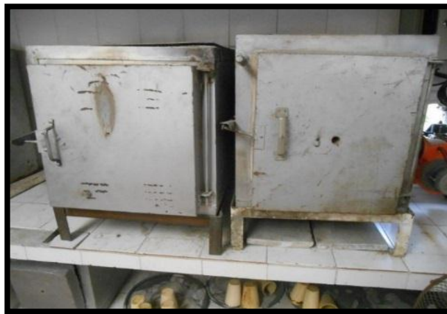
Figura 62. Horno o mufla donde se calientan las muestras; laboratorio mina El Gran Porvenir.
