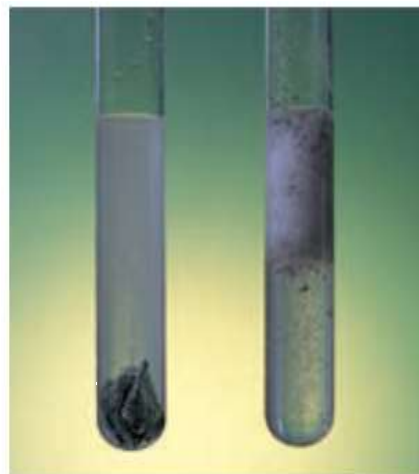
Figura 20. El zinc en virutas (izquierda) y en polvo (derecha) y el ácido clorhídrico (reactivos) reaccionan para formar cloruro de zinc (producto).
