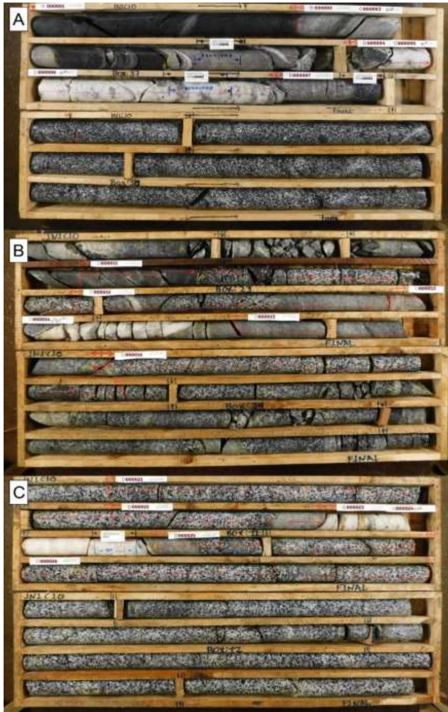
Figura 18. Fotografías de testigos de perforación (intervalos de muestreos) Nota. Fotografías que muestren intervalos de muestreos en tres pozos diferentes, así como algunas muestras de densidad. A- Se observa que la muestra D000003 corresponde a una muestra de control (DUP), duplicado de pulpa; la muestra D000005 corresponde a un (BLF), blanco fino; la muestra D000006 corresponde a un (BLG), blanco grueso. B- la muestra D000014 corresponde a un estándar. C- Se observa que la muestra D000024 corresponde a una muestra de control (DUG), duplicado grueso.
