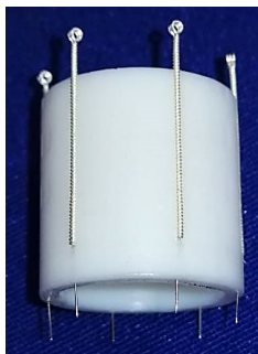
Figura 8. Diseño real del dispositivo con 6 agujas de acupuntura adheridas.
