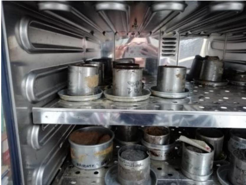
*Ilustración 30. Cilindros con muestras del suelo en el horno
