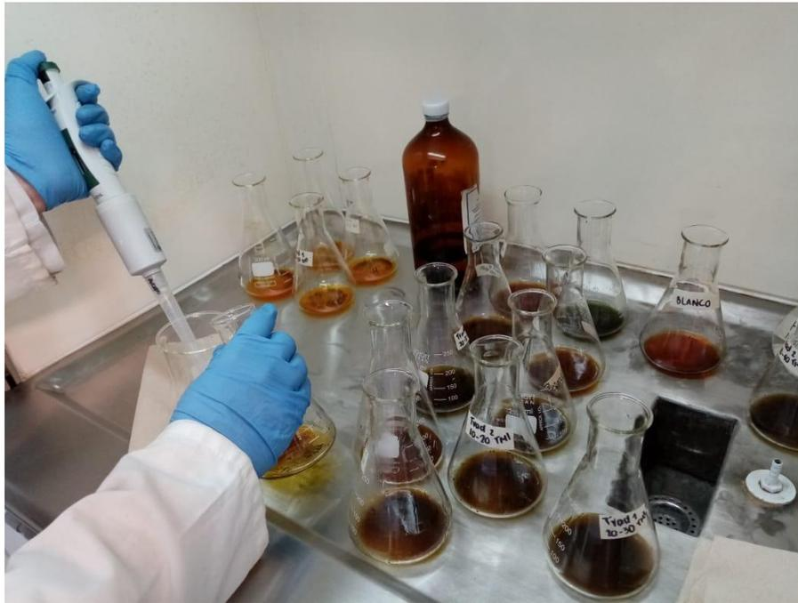
Ilustración 28. Erlenmeyer con 10ml de ácido sulfúrico concentrado Fotografía del Autor
