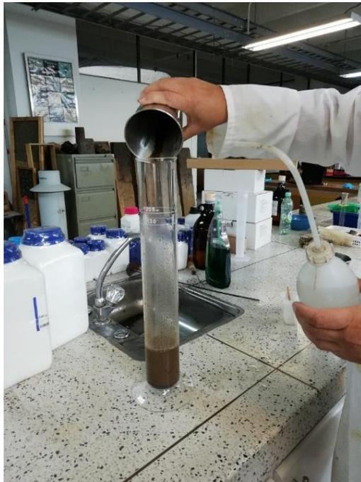
*Ilustración 32. Traspaso de muestras a cilindro de vidrio
