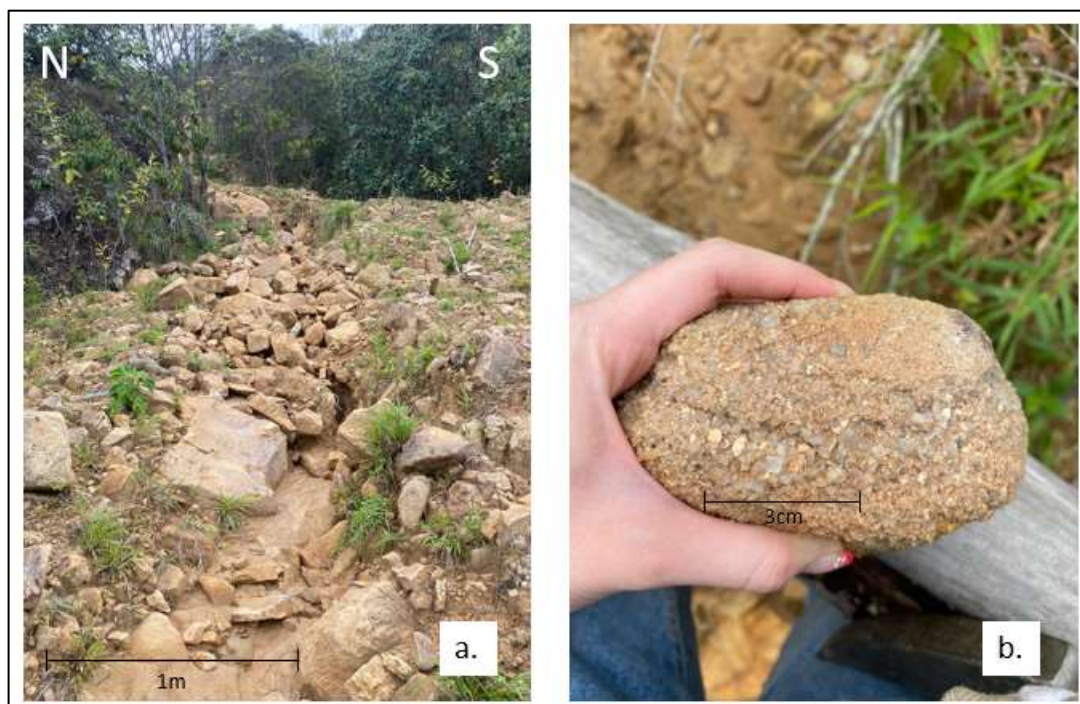
Figura 32. Afloramiento de la unidad geológica superficial: suelo transportado coluvial. a) Suelo transportado coluvial perteneciente a la Formación Caballos. b) Fragmento de roca del depósito. Fuente: propia.
