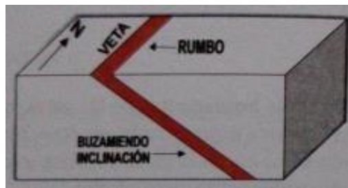
Figura 55. Bloque-diagrama para ubicar el rumbo y buzamiento de una estructura mineralizada (veta).
