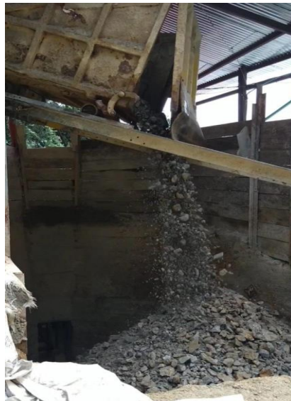
Figura 39. Manera en que es descargado el material del skip en la tolva de la planta de beneficios.
