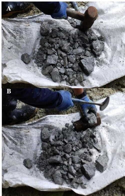
Figura 47. Homogenización por esfuerzo mecánico con ayuda de: A) Una comba de 3 libras. B) Un martillo geológico.
