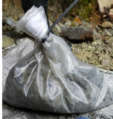
Figura 34. Se indica la manera como debe ser sellada la muestra obtenida.
