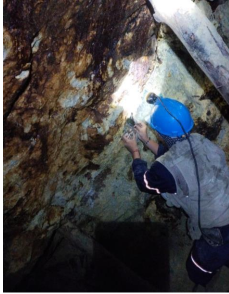
Figura 59. Personal de geología indicando la manera cómo debe ser medido el buzamiento. Foto tomada en el S/N 1822.
