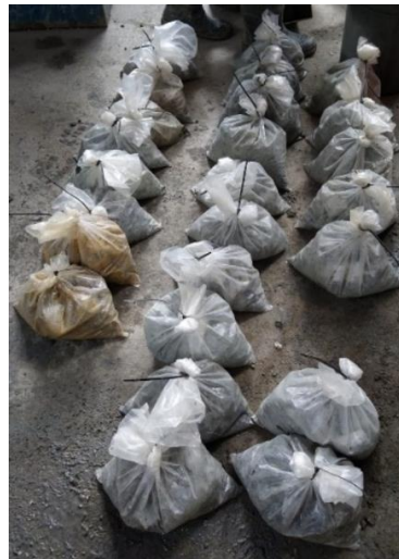
Figura 36. Se indica la manera en que deben ser entregadas las muestras al personal de laboratorio.
