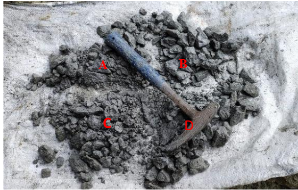
Figura 50. Separación de la muestra en cuatro partes iguales.
