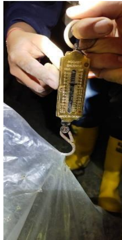
Figura 28. Se indica la manera como debe ser pesada la muestra obtenida y se señala que efectivamente tiene el peso indicado (3 kg).
