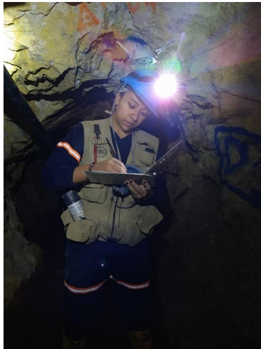
Figura 54. Personal de geología realizando el levantamiento geológico subterráneo (se observan algunos de los implementos de mapeo que se utilizan).
