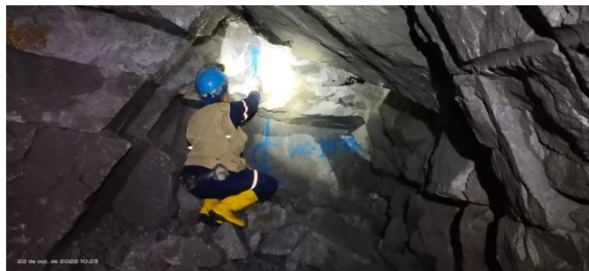
Figura 73. Personal de geología realizando el respectivo marcado con aerosol para la apertura de un nuevo crucero (1823).
