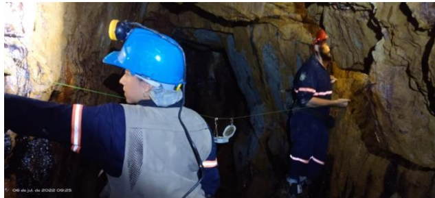
Figura 72. Personal de geología realizando el procedimiento de trazado de crucero.
