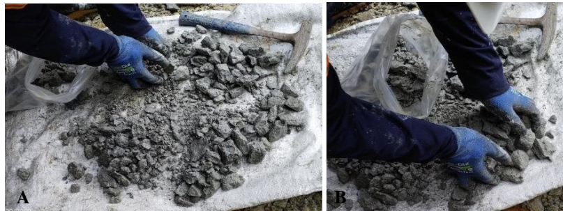
Figura 51. A) Toma de la porción A de la muestra de la figura 50. B) Toma de la porción D de la muestra de la figura 50.
