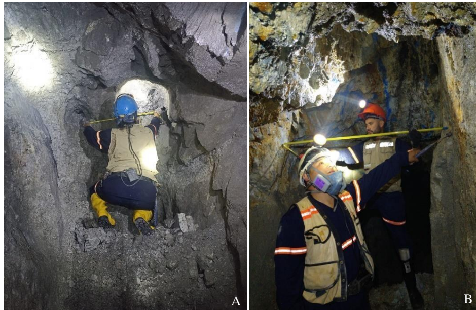
Figura 21. A) Personal de geología midiendo la potencia de veta en el S/N 1883 S (CHI6). B) Personal de geología midiendo el ancho minado en el S/N 1890 N (VTN).
