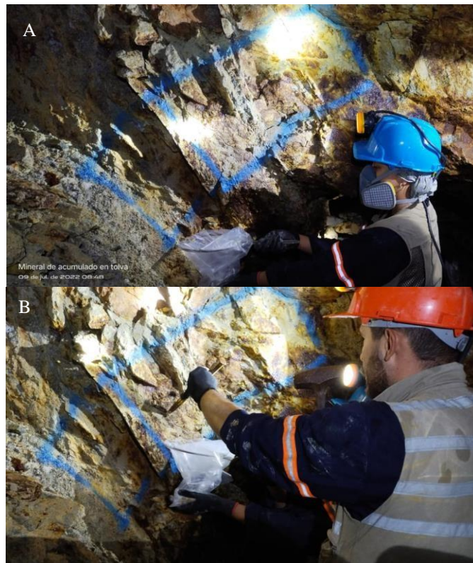
Figura 27. A) Manera como debe ser sostenido el aro metálico (ayudante) y la bolsa de polietileno. B) Manera en que debe ser extraída la porción de mineral para ser almacenada en la bolsa de polietileno.
