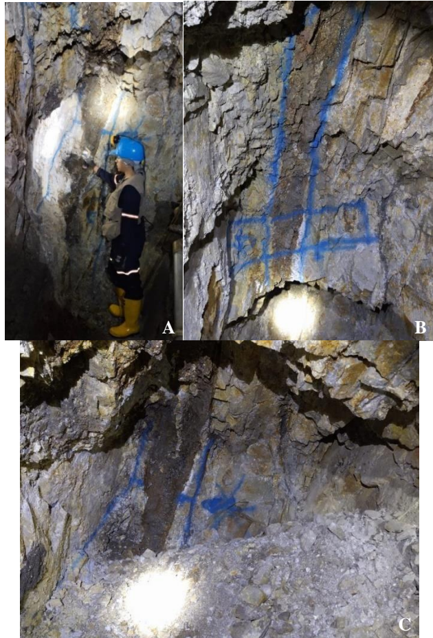
Figura 20. A) Personal de geología realizando el trazado de la veta en el S/N 1891 S. B) Veta trazada en el S/N 1891 S. C) Veta trazada y canal marcado en el S/N 1890 (VTN) (El procedimiento del marcado del canal se explicará más adelante).
