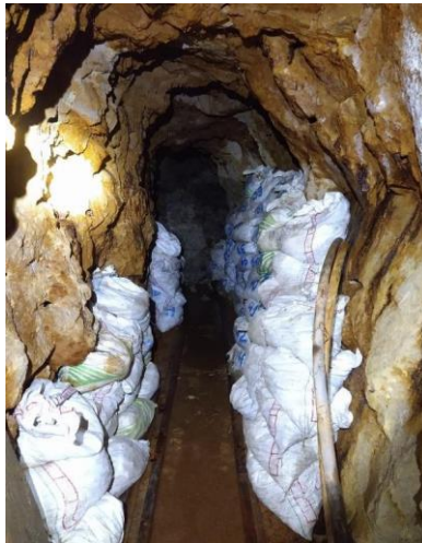
Figura 17. Material en costales extraído por método de circado en donde se puede apreciar la numeración con aerosol azul. Foto tomada en el S/N 1890 N (VTN).
