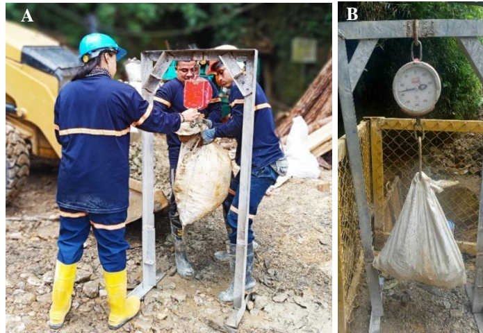
Figura 18. A) Personal de geología y personal de mina realizando el pesaje de costales de mineral extraído por el método de circado. B) Manera en que debe ser pesado el costal en la báscula romana.
