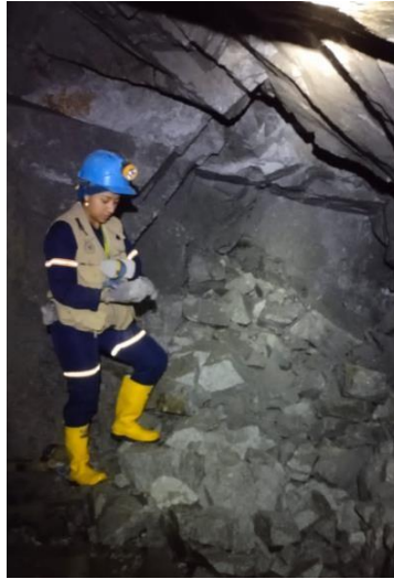
Figura 16. Personal del área de geología evaluando la calidad de la carga de voladura. Foto tomada en el crucero 1824.
