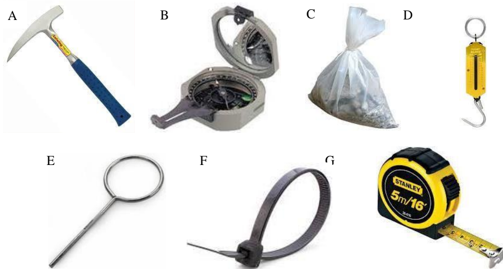
Figura 8. Herramientas del área de geología. A. Martillo geológico. B. Brújula. C. Bolsas de polietileno. D. Balanza romana. E. Aro metálico o ayudante. F. Precinto de seguridad. G. Flexómetro.
