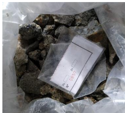
Figura 33. Ticket insertado en una bolsa para que la humedad de la muestra no lo deteriore.
