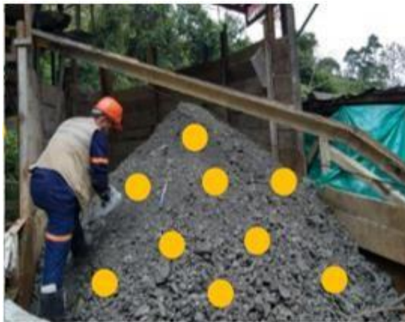
Figura 43. Personal de geología realizando la extracción de la muestra en tolva por el método de puntos.
