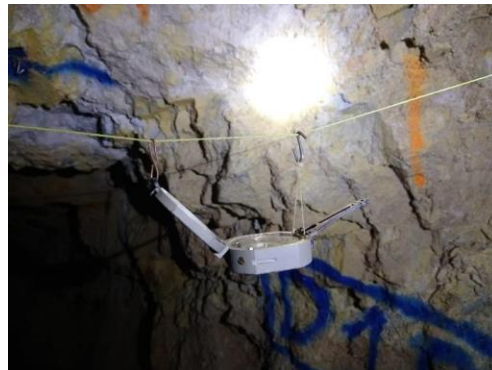
Figura 57. Manera como debe ir colgada la brújula en el cordón.
