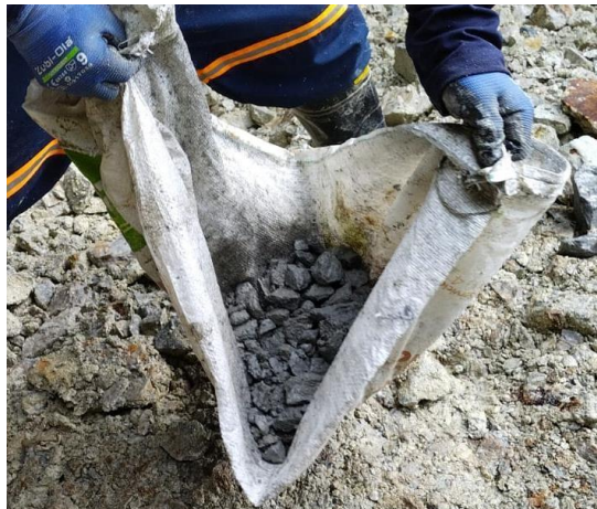
Figura 49. Mezcla de la muestra en la lona.
