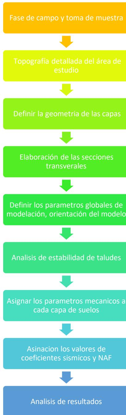
*Figura 12. Flujograma representativo de la metodología seguida para el análisis de estabilidad de taludes.*
