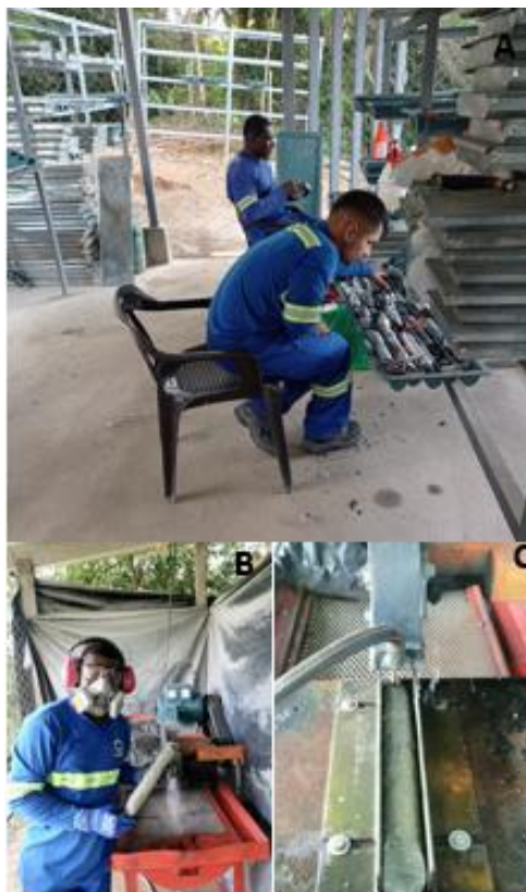
Figura 33. Proceso general de encintado y corte de muestras A. Núcleos debidamente encintados para su posterior corte. B. Personal encargado del corte de núcleos junto a máquina cortadora. C. Núcleo ubicado momentos previos antes de pasar a la cortadora.
