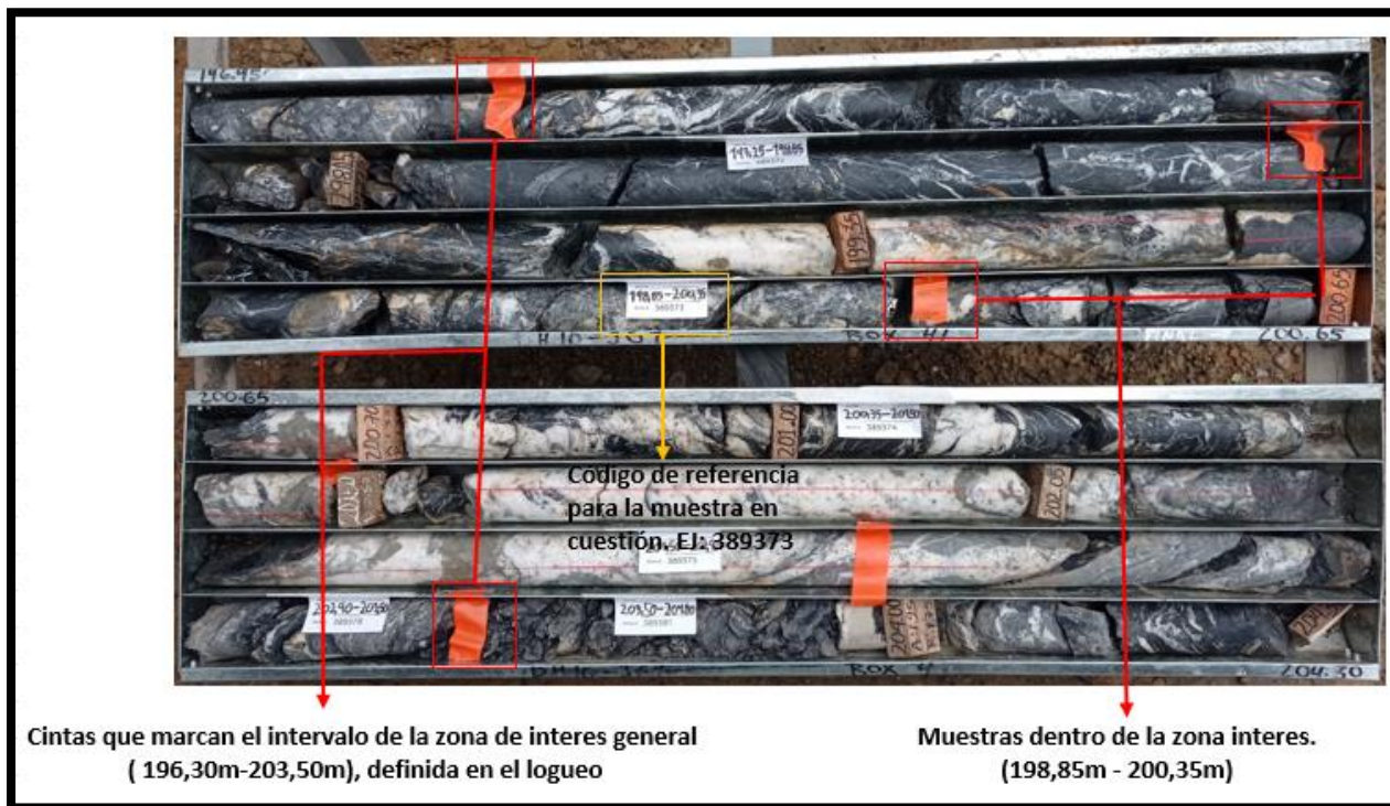
Figura 32. Ejemplo de delimitación y etiquetado de muestras. Nótese los intervalos marcados con cintas de color naranja (recuadros pequeños en rojo) y las etiquetas de muestreo (recuadro grande en amarillo).
