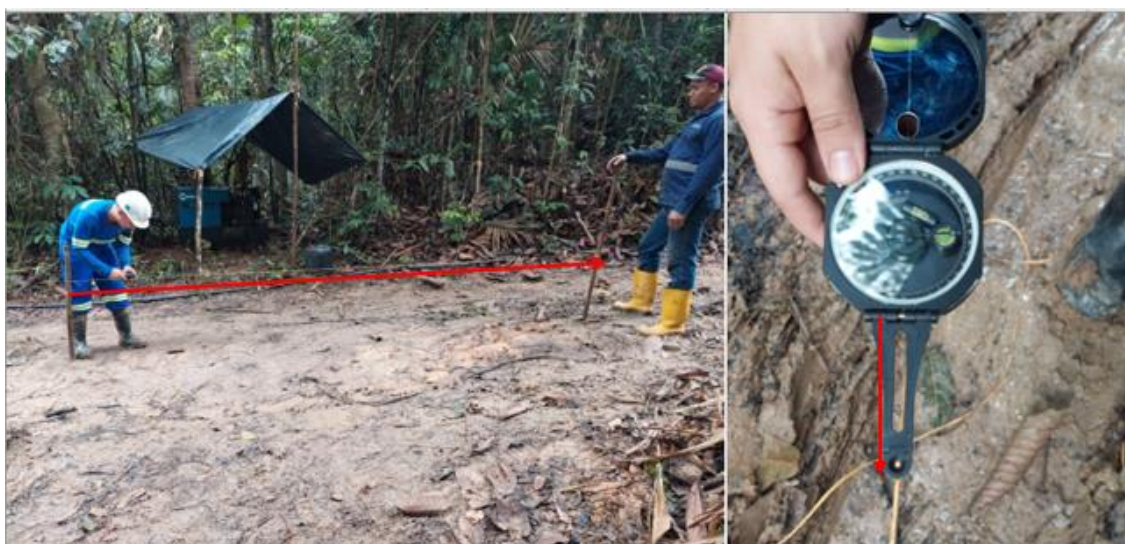
Figura 20. Plataforma de perforación en superficie en donde se está buscando la línea de azimut con brújula para posicionar equipo de perforación.
