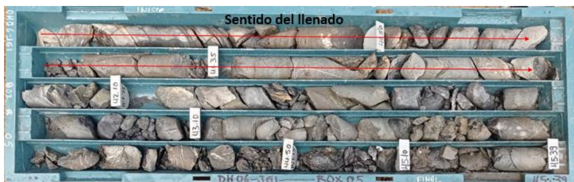
Figura 22. Caja porta testigo donde se indica el llenado correcto .
