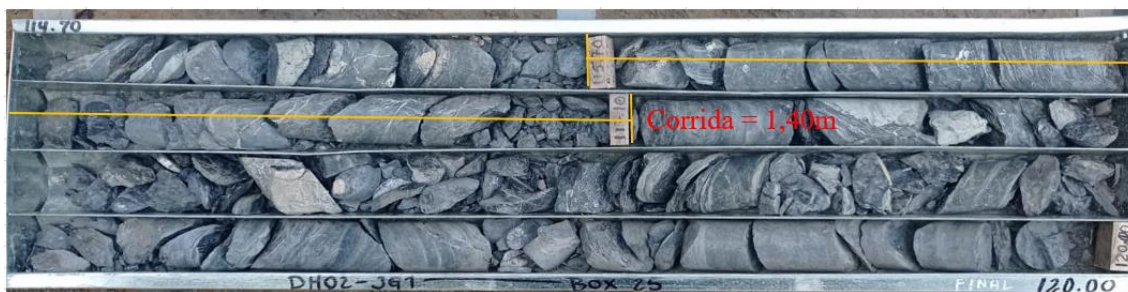
Figura 28. Intervalo de corrida 1.40m con una recuperación de núcleo de 0.80 m , lo que en porcentaje representa una recuperación del 57.1%. Nótese el alto fracturamiento del núcleo, lo que puede representar una zona de cizalla fuerte y pérdidas considerables en la recuperación.
