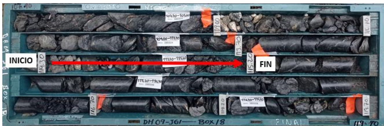
Figura 26. Chequeo de los tacos que marcan profundidad en una caja de almacenamiento de núcleos.
