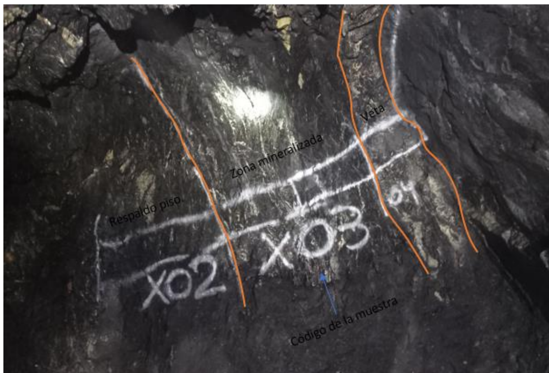
Figura 56. Muestreo de canal donde se aprecia muestras en los diferentes sectores de la frente.
