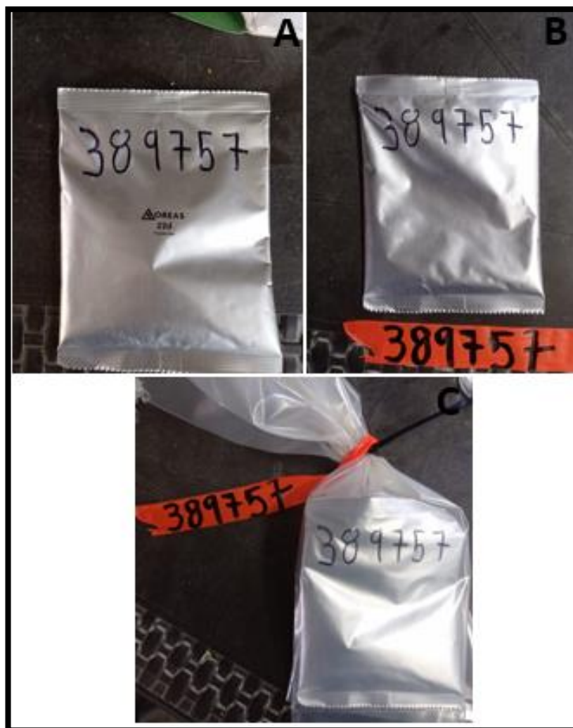
Figura 41. Saches de 60 gramos de blanco fino, utilizado en control de la contaminación en el laboratorio: Nótese que al empaque original se le ha borrado el código y se asignó otro correspondiente al consecutivo de la muestra en el lote.
