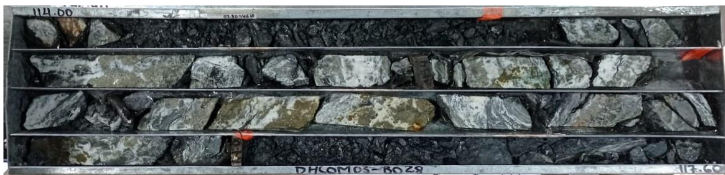
Figura 35. Testigos de perforación después de haber sido muestreados. Nótese que se preservan las mitades de la sección muestreada.
