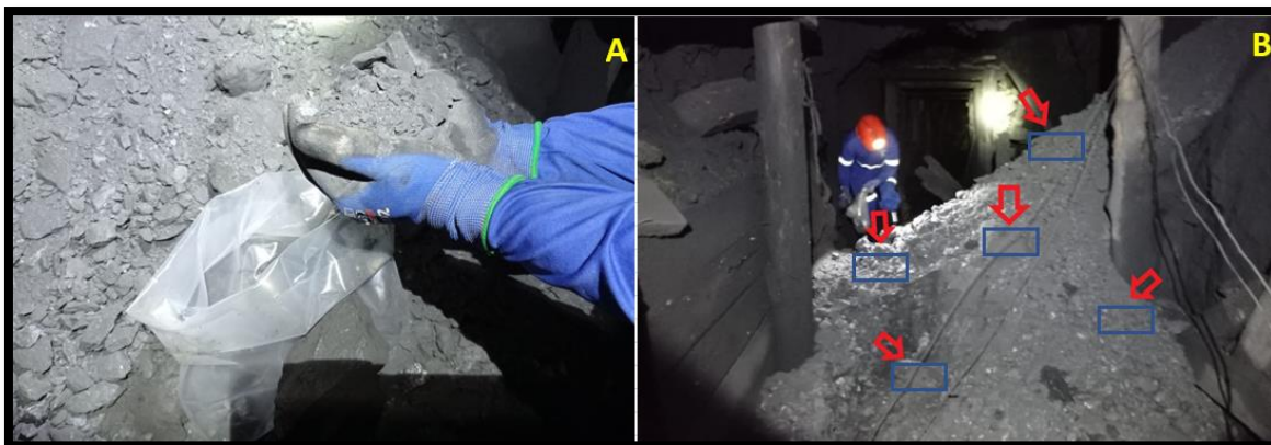
Figura 60. Muestreo Grab. A. Ejemplo de recolección de muestras. B. Puntos de muestreo dentro de la pila.
