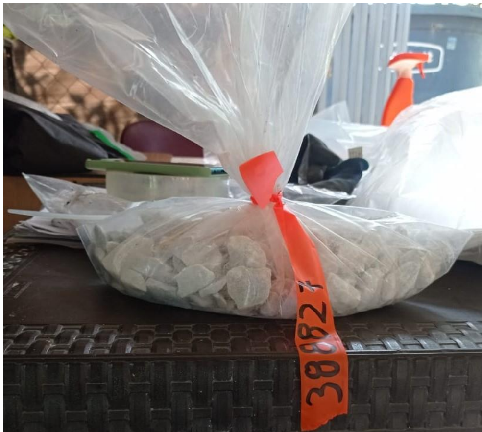
Figura 40. Muestra de blanco grueso utilizada para medir contaminación en los procesos del laboratorio y garantizar confiabilidad en resultados de muestras. Se aprecia el tamaño de fragmentos que son enviados en la muestra y que deberán pasar por la etapa de trituración en el laboratorio. Peso de la muestra es de 1.5Kg.
