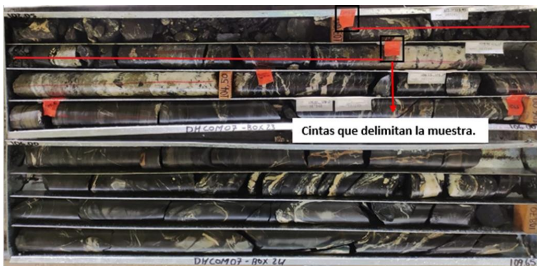
Figura 31. Marcas de muestreo señalizadas con cinta color naranja.
