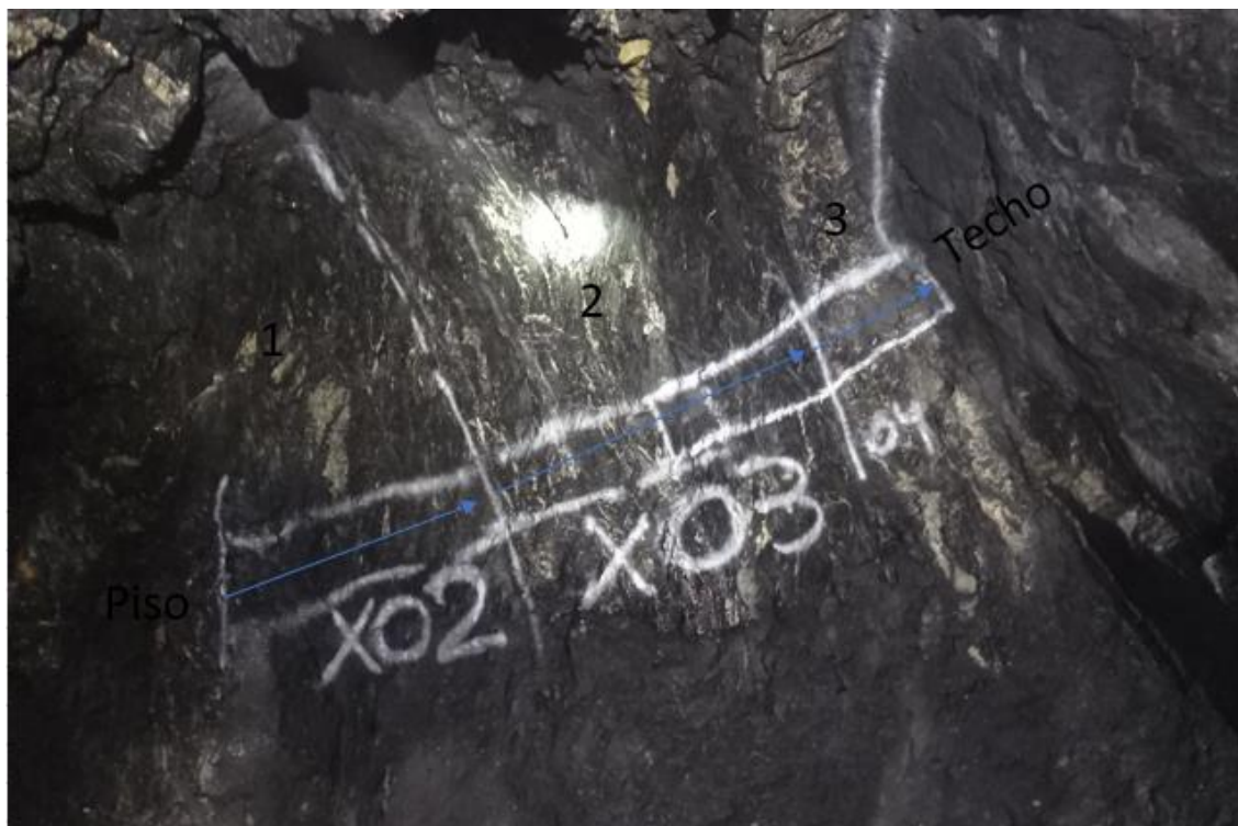
Figura 57. Orden en que se deben realizar la muestra. Dirección preferencial de muestreo.
