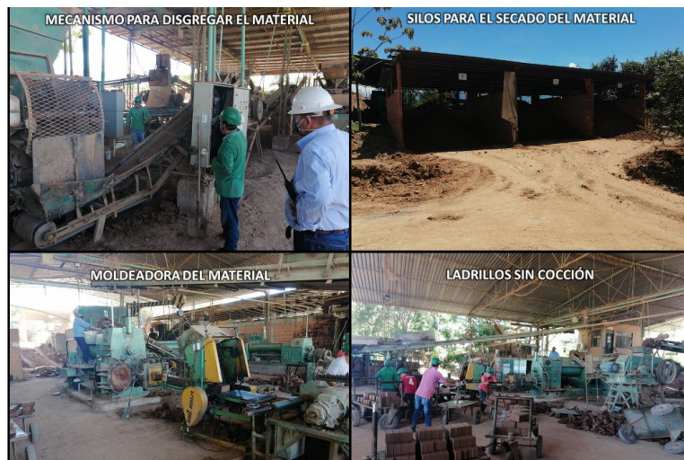
Registro fotográfico 41. Cadena de producción de ladrillo. Fuente propia.
