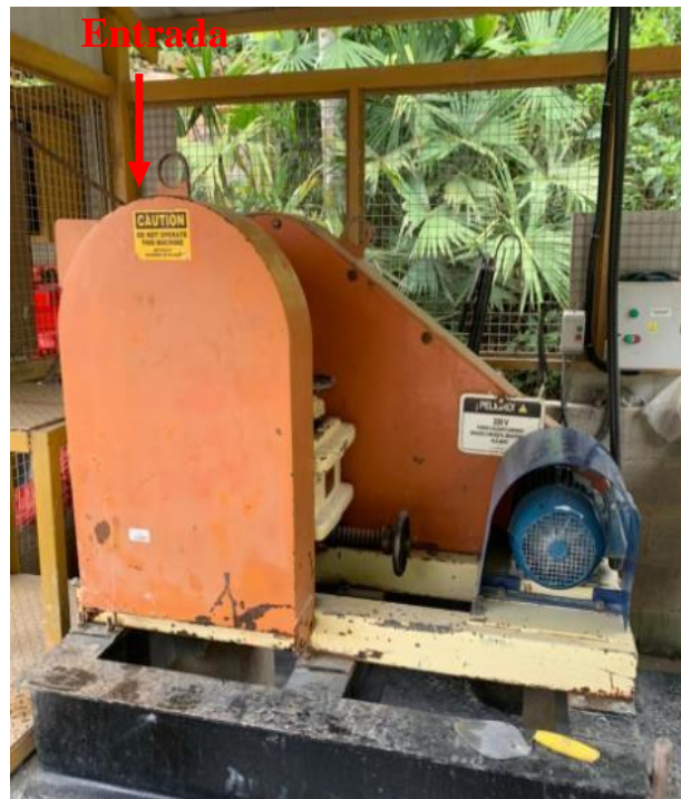
Imagen 39. Trituradora a donde son llevados los grabs obtenidos de las pilas, la flecha representa en donde ingresa el material para ser triturado; Fuente: propia.
