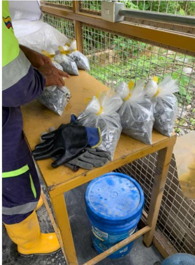
Imagen 41. Empacado y sellado del producto del cuarteo, cada bolsa cuenta con sus respectivos sellos de seguridad de color amarillo y ficha (código de muestra); Fuente: propia.
