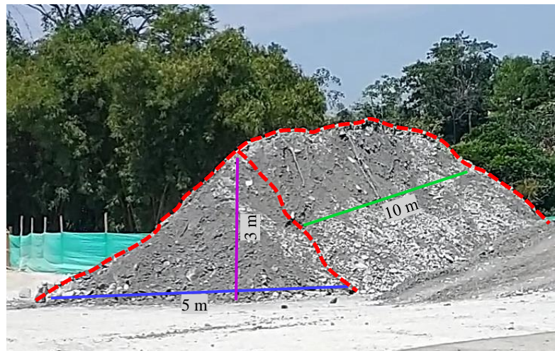
Imagen 35. Dimensiones de una pila promedio de 400 toneladas, las líneas continuas representan las longitudes de cada cara, por otro lado, las líneas rojas discontinuas representan los límites de las caras; Fuente: propia.
