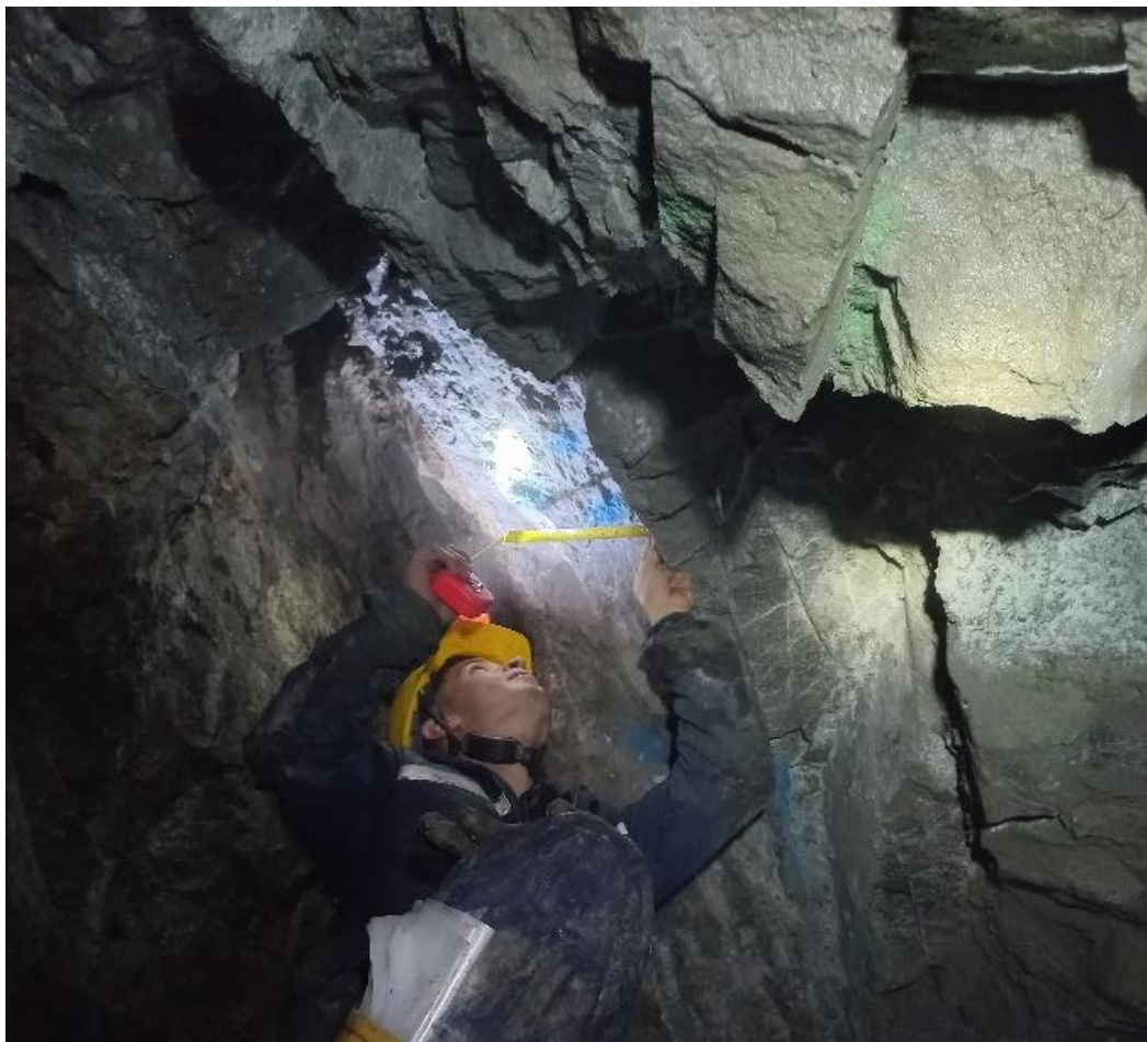
Figura 18. Personal de geología tomando dato de ancho de estructura, se realiza con flexómetro en el punto medio del frente de explotación; si la veta es mas ancha o angosta en algunos puntos, se toman todas las medidas y se promedia este ancho.
