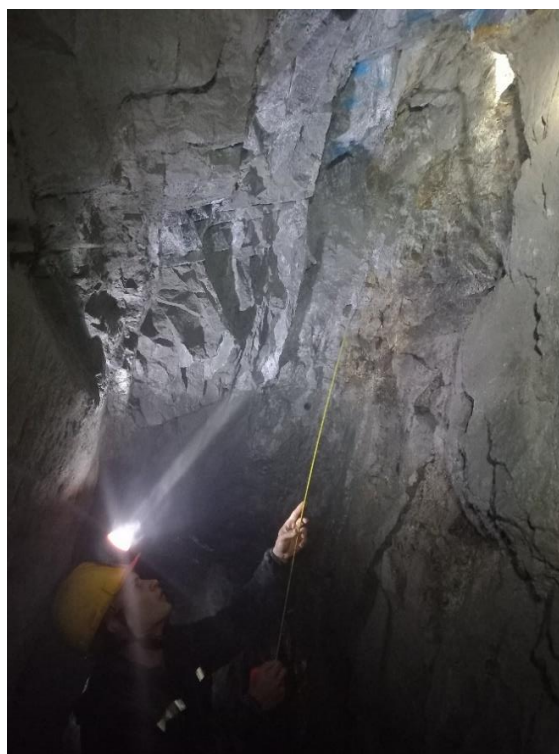
Figura 19. Personal de geología tomando dato estructural de la estructura mineralizada, se obtiene con una brújula en planos representativos, de igual manera se realiza para las fallas.
