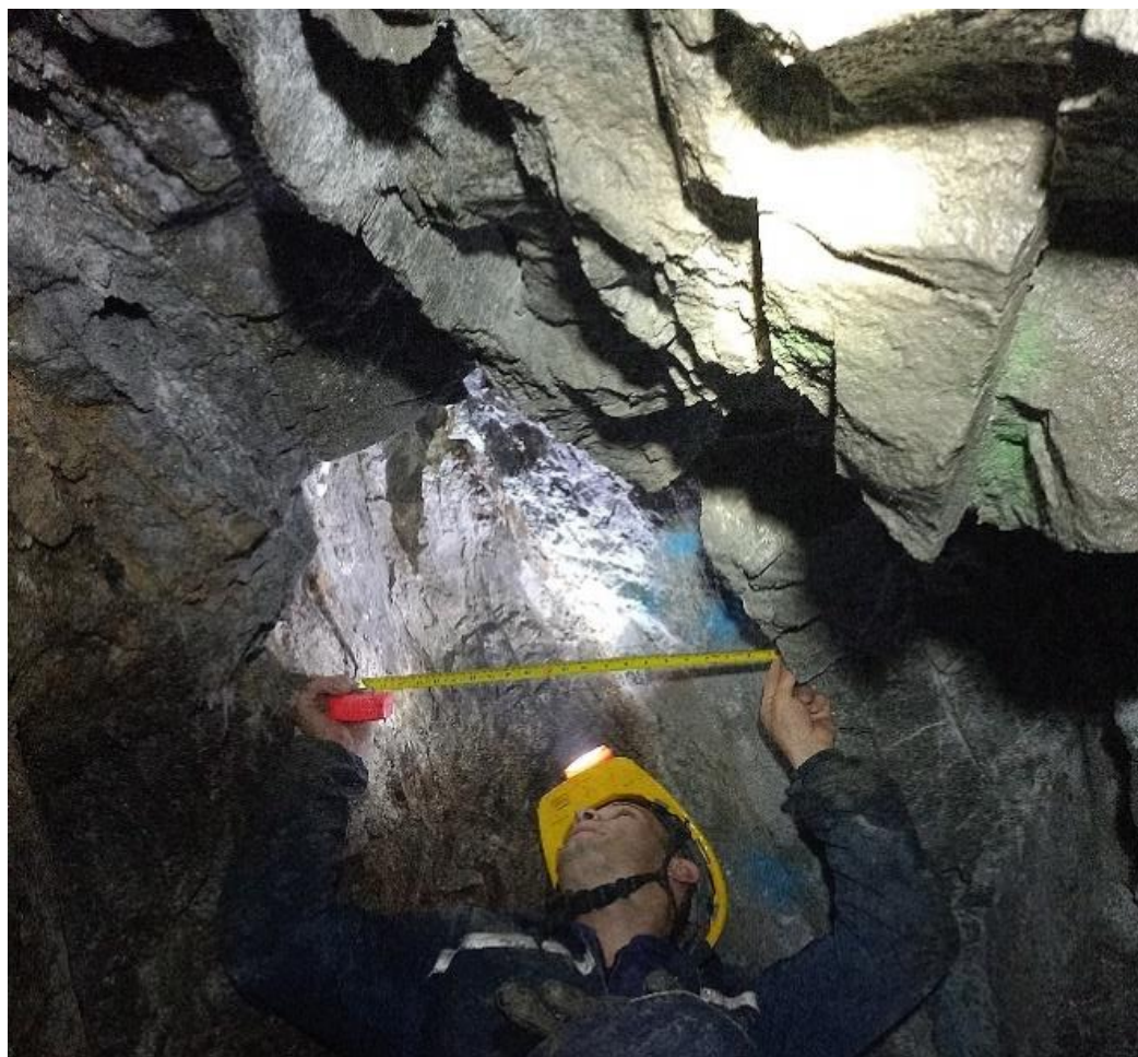
Figura 17. Personal de geología tomando dato de ancho de labor, se realiza con flexómetro en el punto de mayor apertura del frente de explotación.
