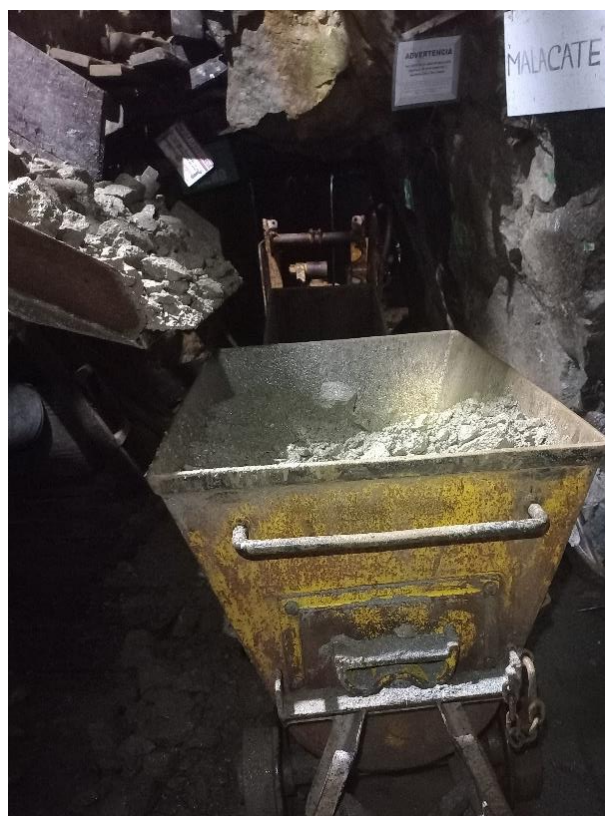
Figura 24. Vagoneta con capacidad de 0.7 toneladas, siendo cargada con material elevado del nivel 1 por el malacate.
