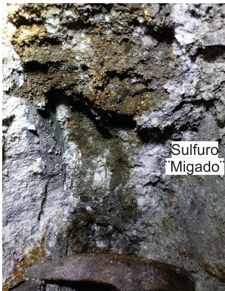
Figura 27. Ejemplo de sulfuro "Migado", este se encuentra de una manera muy similar a la escarcha dorada. En la Mina Mococongo funciona como guía mineralógica de zonas ricas.
