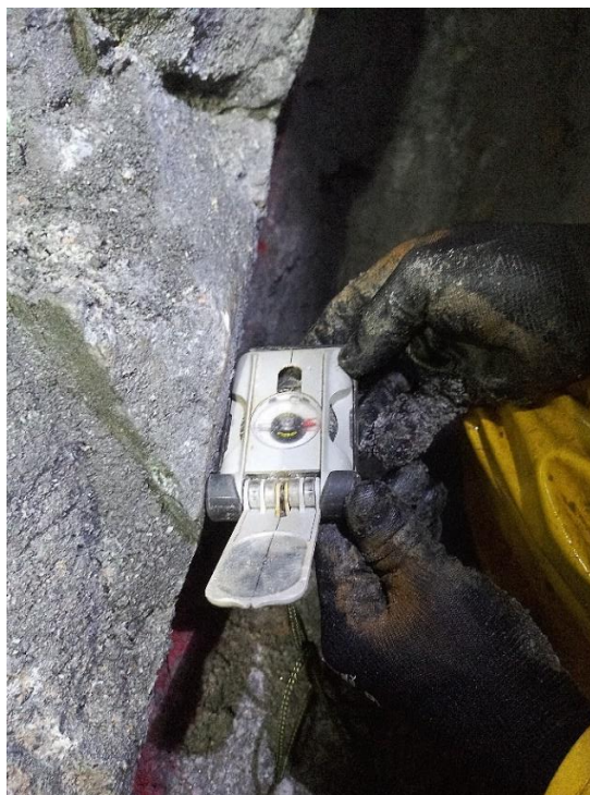
Figura 19. Personal de geología tomando dato estructural de la estructura mineralizada, se obtiene con una brújula en planos representativos, de igual manera se realiza para las fallas.
