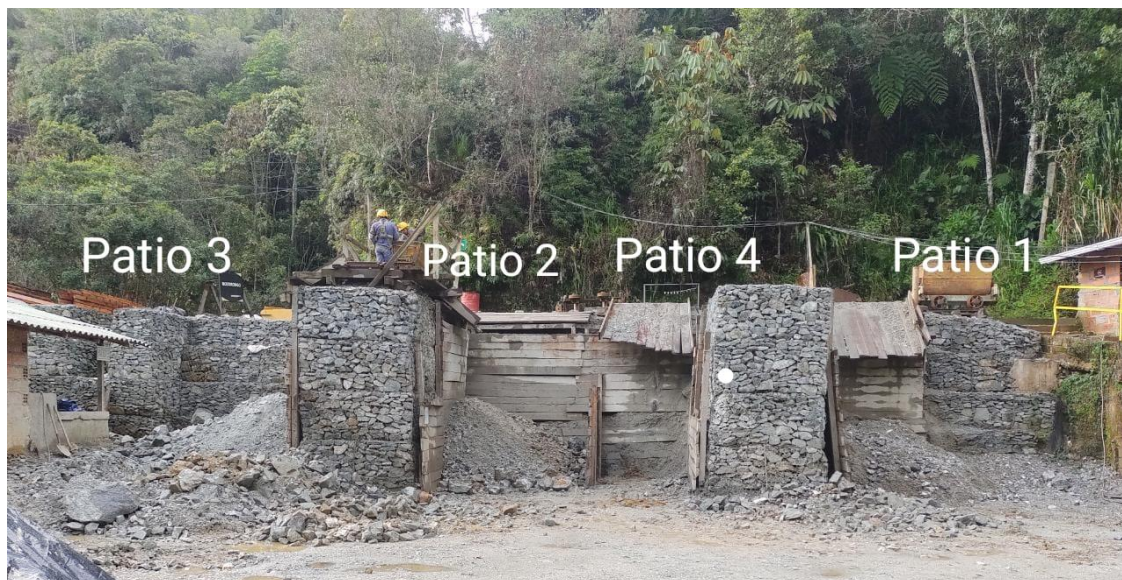
Figura 25. Acopios de la Mina Mocerongo; de izquierda a derecha: Acopio o Patio 3, para carga estéril; Acopio 2, para cargas con tenor entre 3 y 10 gramos/Ton; Acopio 4, para cargas sin tenor determinado y Acopio 1 para cargas con tenor mayor a 10 gramos/Ton.
