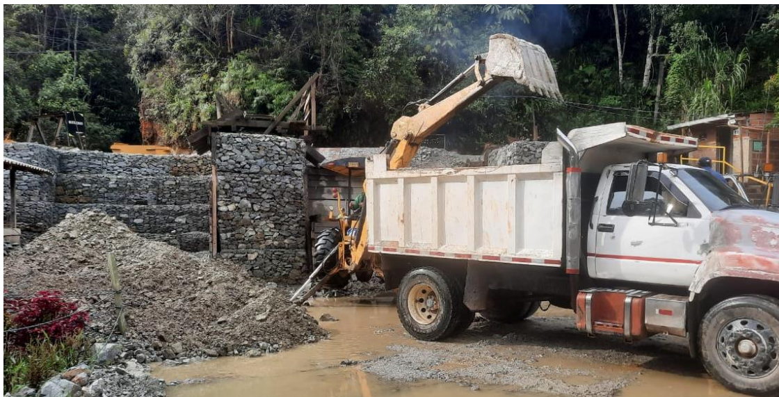
Figura 33. Volqueta de 15 toneladas siendo cargada por retrocargador con material de venta.
