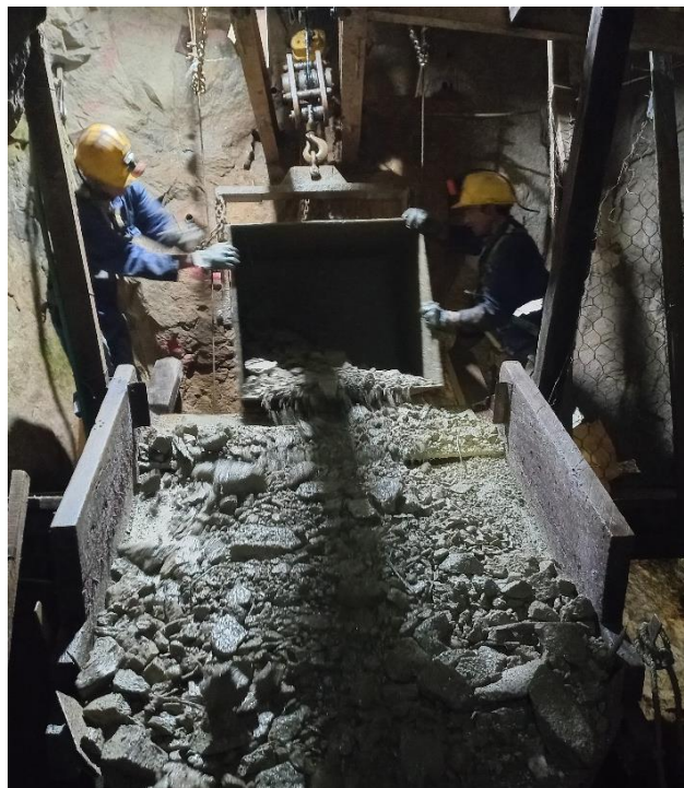
Figura 23. Malacate ubicado en la clavada 1, eleva todo el material proveniente del nivel 1; tiene una capacidad aproximada de 1 tonelada; aquí se cargan las vagonetas que son empujadas hasta los acopios en el campamento.
