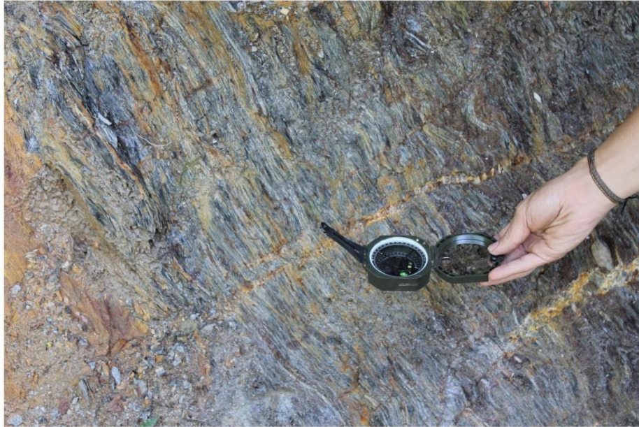
Figura 3. Esquistos grafitosos del Complejo Cajamarca, observados dentro de la concesión minera. Corresponde a la roca caja de la mineralización. Se evidencian dos venillas de cuarzo y carbonatos que la atraviesan.
