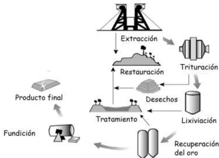
Figura 2. Esquema del proceso de lixiviación del oro. Adaptado de Botz et al. 2016 [18].
