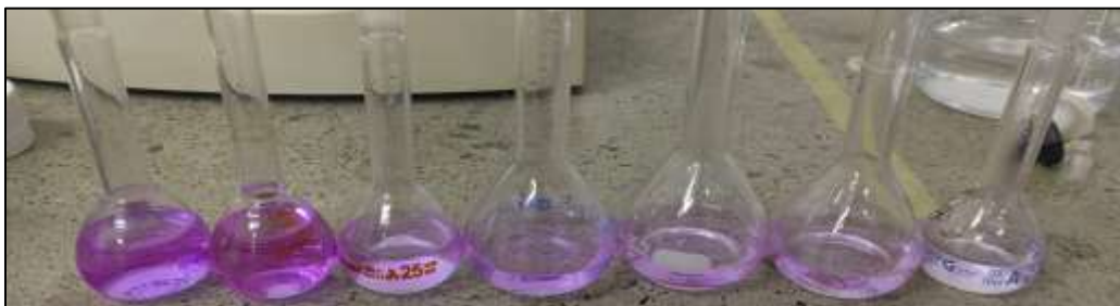
Figura 47. Resultados de la determinación de cianuro en el reactor por colorimetría
