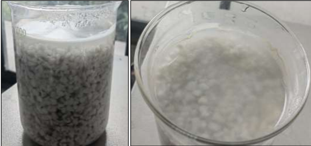
Figura 45. Formación de biopelícula en los soportes de arenisca después de 5 días de reacción.
