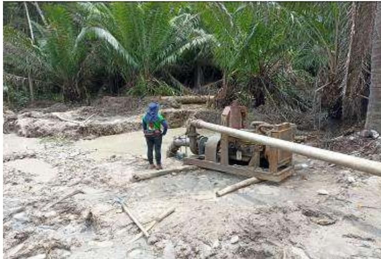
FIGURA 8. Motobomba de fosa, reportada en vereda El Llano municipio de Victoria
