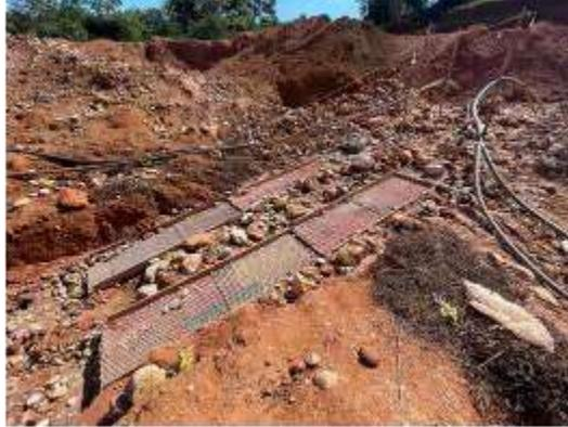
FIGURA 11. Canaleta clasificadora de madera reportada en vereda Quebra de Roque municipio de Norcasia
