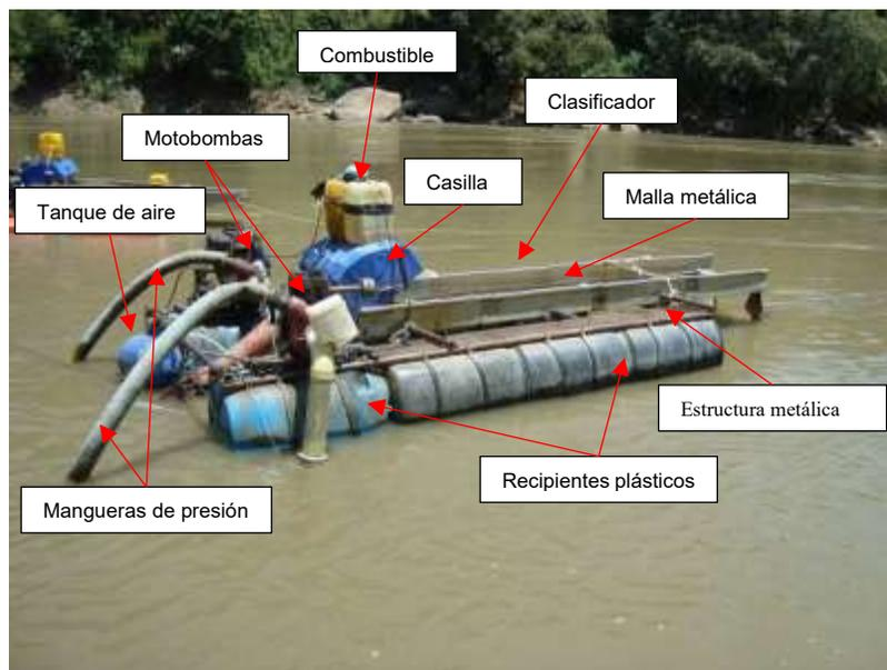
FIGURA 16. Explotación de oro aluvial – minidragas
