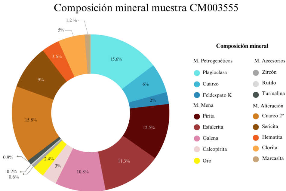
Figura 22. Diagrama circular porcentual de composición mineral para muestra CM003555 discriminado por minerales petrogenéticos, de mena, accesorios y de alteración.
