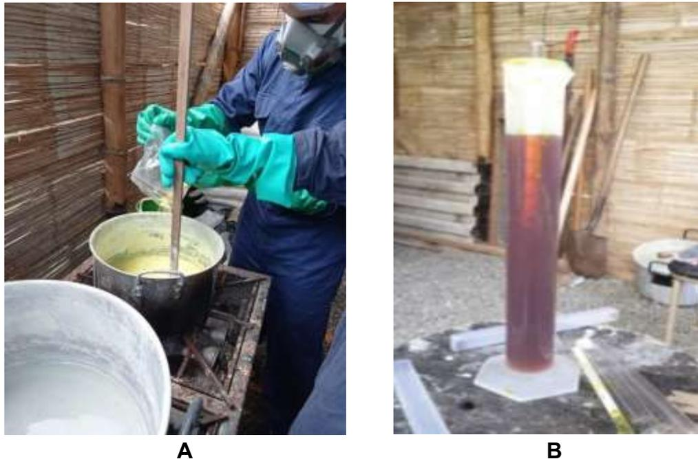
**Figura 4.** Caldo sulfocálcico. A: Preparación del producto. B: Medición de los grados Baumé. Fuente:(García, 2017).
