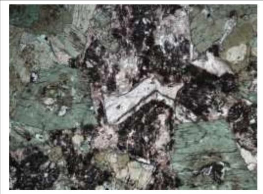
**Nota:** Zoisita/Clinzoisita (Zo/Czo) creciendo junto con la epidota, producto de alteración de una plagioclasa, anfíboles (Amp) con zonación (Bordes de diferente color de interferencia), alterándose a clorita (Chl) y epidota (Ep), adicionalmente se observa mucha saussurita (Sau) producto de alteración de plagioclasas.
