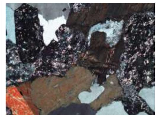
**Nota:** Biotita (Bt) con interdigitaciones en los bordes con una plagioclasa (Pl) las cuales están altamente alteras a saussurita (Sau) y Sericita (Ser), se observa anfíbol (Amp) con macla simple, siendo remplazado por minerales opacos (Opq) y cuarzo (Qz) relleno de espacios entre minerales.
