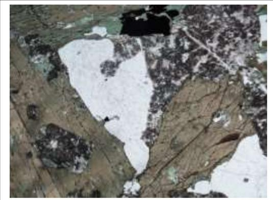
**Nota:** Saussurita (Sau) a partir de una plagioclasa Poiquilítica en anfíbol (Amp), el cual esta alterado a clorita (Chl), epidota (Ep) y es remplazado por minerales opacos (Opq), se observa sericita (Ser) a partir de la alteración de plagioclasa, adicionalmente cuarzo (Qz) relleno de espacios entre minerales.
