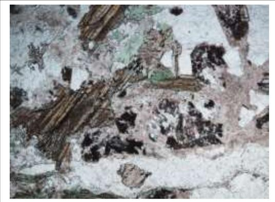
**Nota:** Cuarzo (Qz) junto con Biotita (Bt) alterándose a clorita (Chl) con planos de exfoliación rellenos de epidota (Ep) y Zoisita/Clinzoisita (Zo/Czo), plagioclasas (Pl) las cuales se encuentran alteradas a Saussurita (Sau) y sericita (Ser), adicionalmente una venilla de carbonato (Cb) con epidota (Ep).
