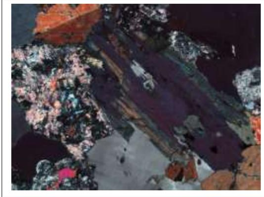
**Nota:** Biotita (Bt) altamente alterada a clorita (Chl) y titanita (Ttn), adicionalmente está siendo remplazado por minerales opacos (Opq), se observa saussurita (Sau) y sericita (Ser) producto de alteración de una plagioclasa, también se observa cuarzo (Qz) y anfíbol (Amp) con macla simple.
