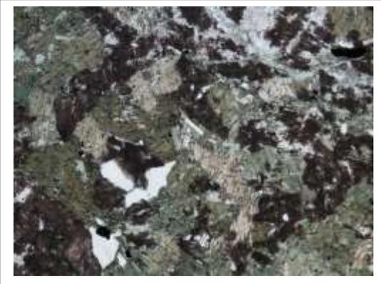
*Nota:* Apatito (Ap) dentro de un anfíbol (Amp), algunos de los anfíboles (Amp) se encuentran alterados a epidota (Ep), saussurita (Sau) siendo remplazada por titanita, sericita (ser) y carbonatos (Cb) formados por alteración, a partir de plagioclasas, se observa también cuarzo (Qz) relleno de espacios entre minerales y también junto con un mineral opaco (Opq).
