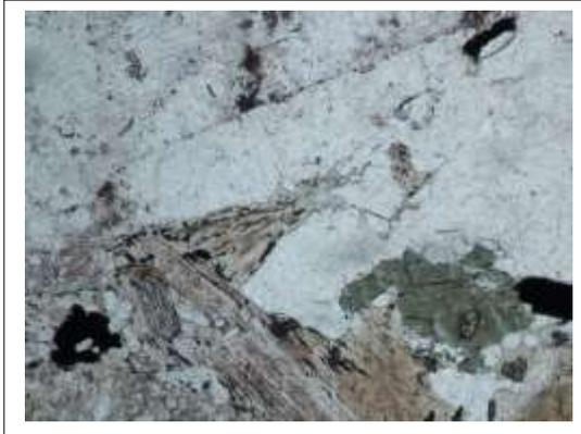
**Nota:** Circón (Zrn) con zonación Incluido dentro de un anfíbol (Amp), el cual se encuentra fuertemente alterado a clorita (Chl), adicionalmente se observa cuarzo (Qz) y plagioclasa (Pl).
