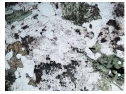
*Nota:* Plagioclasa (Pl) con alteración a saussurita (Sau), sericita (ser) y epidota (Ep), se observa anfíbol (Amp) alterándose a clorita (Chl), adicionalmente se observa cuarzo relleno espacios entre minerales.
