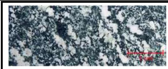
*La alteración es hidrotermal marcada por venillas de cuarzo y carbonatos.*
