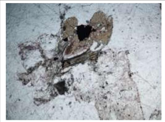
**Nota:** Anfíbol (Amp) siendo remplazado por minerales opacos (Opq), alterándose a clorita y con formación de zoisita clinozoisita en los planos de exfoliación, se observa plagioclasa (Pl) alterándose a epidota (Ep), adicionalmente se observa cuarzo (Qz)
