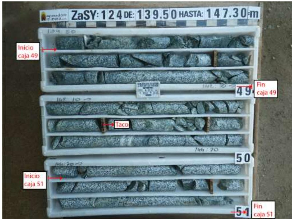
**Figura 5.** Cajas con núcleos de perforación. El logueo se realiza de izquierda a derecha, de menor a mayor profundidad, con ayuda de los tacos que muestran datos de profundidad y teniendo en cuenta la sucesión de las cajas.
