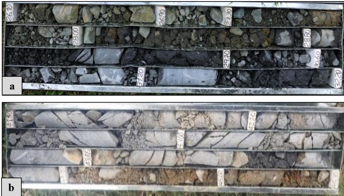
Figura 35. Perforación PS-PR-CO-05 a) Toba de cristales en horizonte de meteorización IIA, resistencia R1, caja #5. b) Protomilonita en horizonte de meteorización IIA, resistencia R1, caja #8
