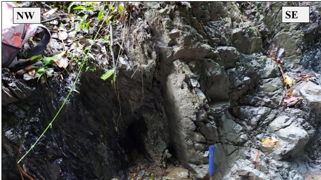
Figura 8. Afloramiento de limolitas en horizonte de meteorización IIB y resistencia R2.
