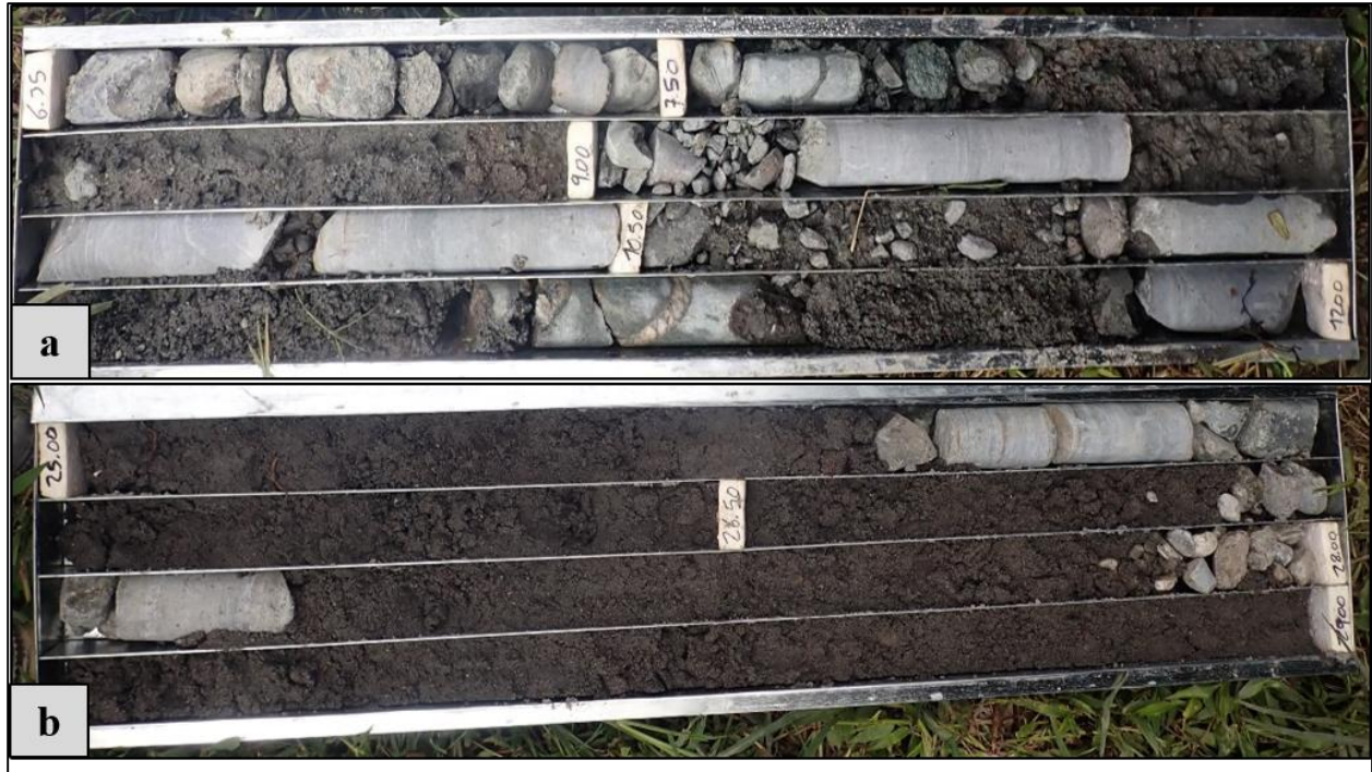
Figura 23. Perforación PS-PR-OD-01. a) Depósito Aluvial clasto soportado, Caja #2. b) Depósito Aluvial clasto soportado, Caja #6
