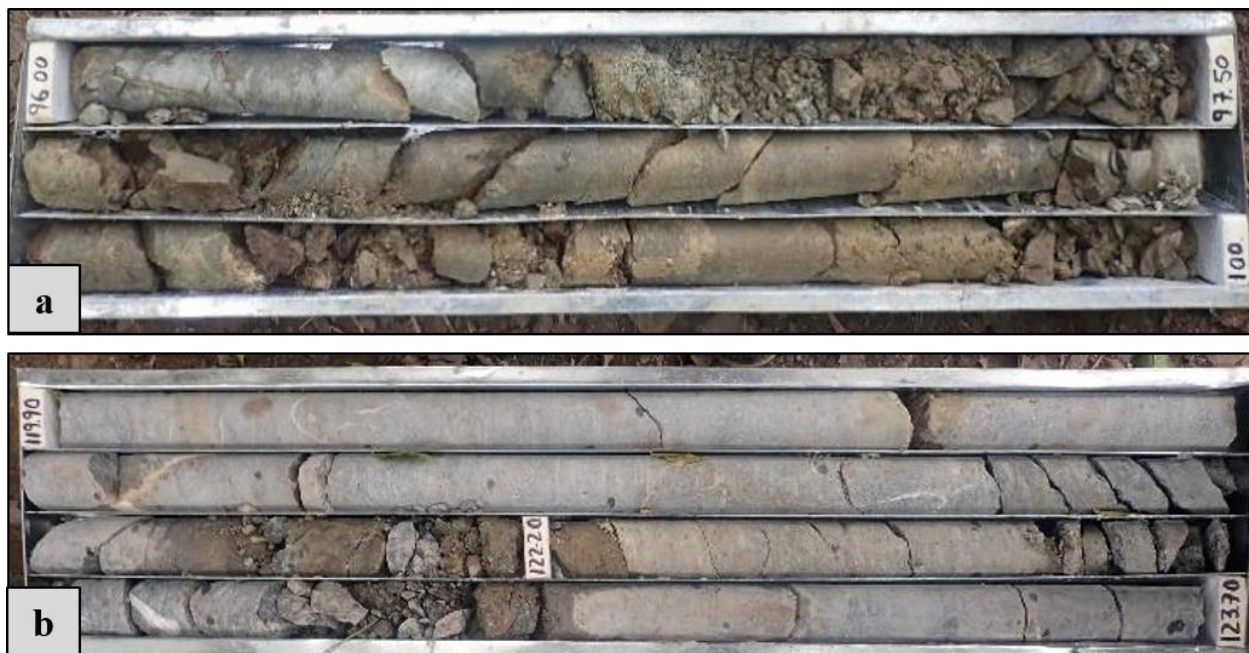
Figura 41. Perforación PS-PR-CO-08 a) Toba de cristales en horizonte de meteorización IIA, resistencia R2, caja #26. b) Grawaca en horizonte de meteorización IIA, resistencia R3, caja #32
