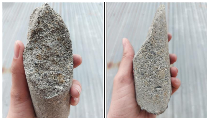
Figura 10. Grauvaca encontrada en perforación PS-PR-CO-02
