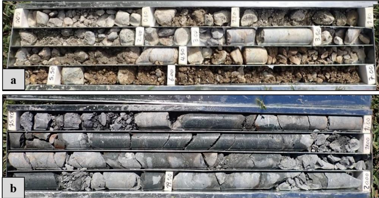
Figura 25. Perforación PS-PR-CM-01. a) Depósito aluvial clasto soportado, caja #1. b) Basalto en horizonte de meteorización IIB y resistencia R2, caja #4
