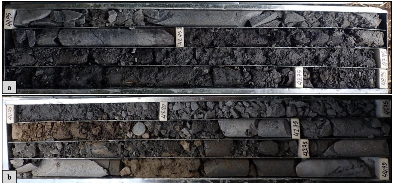
Figura 29. Perforación PS-PR-CO-02. a) Grawaca en horizonte de meteorización IIA y resistencia R1-R2, caja #9. b) Limolita carbonosa en horizonte de meteorización y resistencia R1 caja #10
