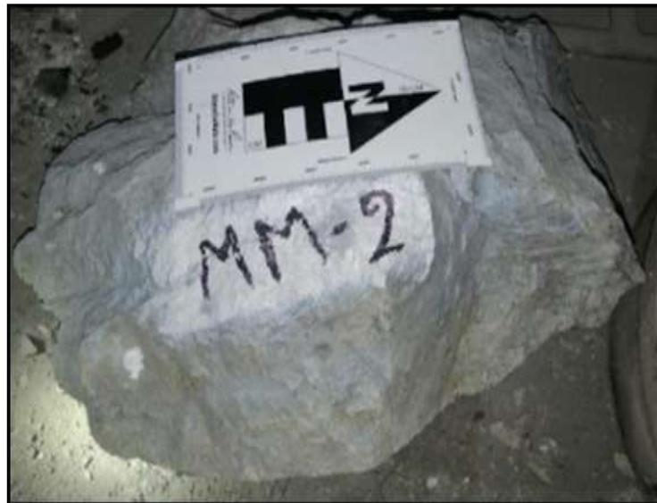
Figura 24. Sulfuro semi-masivo (MM, nomenclatura utilizada por el área de geomecánica) (Departamento de Geomecánica de la Mina El Roble).
