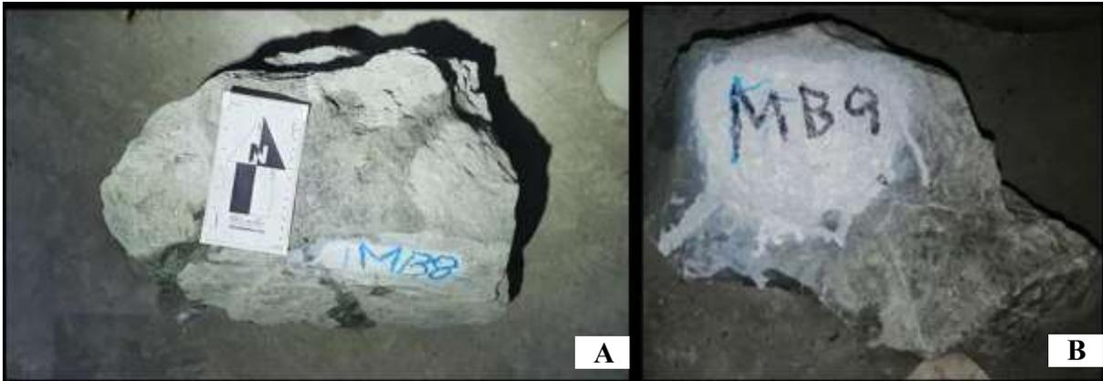
Figura 22. Basalto (MB, nomenclatura utilizada por el área de geomecánica). A) basalto. B) basalto con tonalidad verdosa producto de minerales de alteración (Departamento de Geomecánica de la Mina El Roble).
