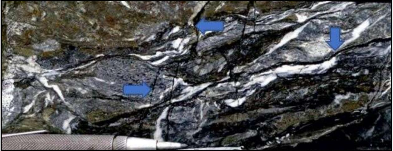
Figura 6. Muestra de Chert negro de la Mina El Roble con aberturas de 1 a 5mm (flechas azules) y rellenos duros de composición calcárea. Modificado de (Espinal-Corrales, 2020).
