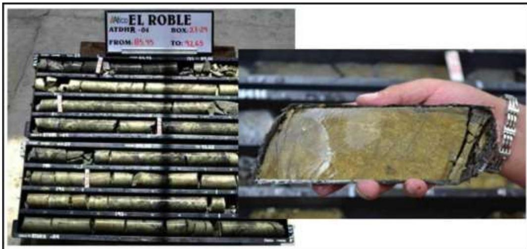
Figura 26. Testigos de perforación del pozo ATDHR-04, a 6.5% Cu y 17.6 g/t Au en el cuerpo de sulfuros masivos “Maximus”. (Echeverri y Salas, 2017).
