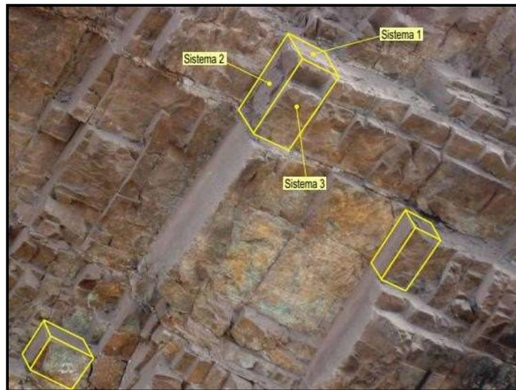
Figura 3. Sistema de discontinuidades con 3 sets de diaclasas en un macizo muy fracturado con formación de bloques de roca (Sociedad Nacional de Minería, Petróleo y Energía, 2004).
