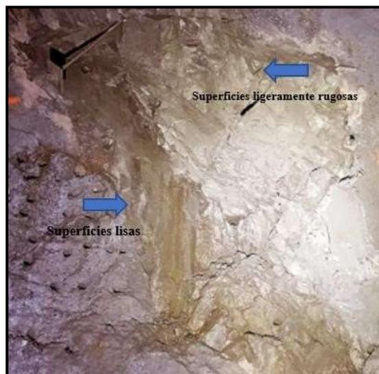
Figura 7. Rugosidad presente en sulfuro, las flechas azules marcan las zonas con diferentes tipos de rugosidad (Fuente propia)
