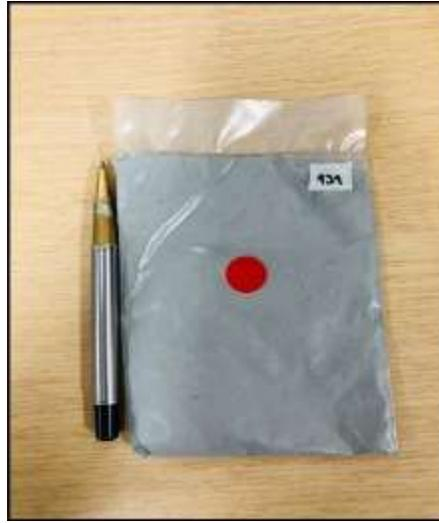
**Figura 24.** Muestra de control correspondiente a un estándar (CSRM- Certified Standard Reference Material).
