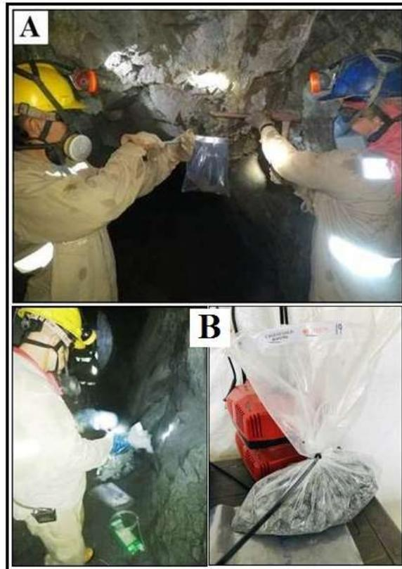
*Figura 13. a. Toma de la muestra con almadana, cincel y bolsa por parte de los auxiliares; b. Muestra empacada, rotulada y lleva su respectivo sello de seguridad.*
