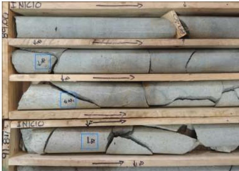
*Figura 18. Marcaje metro a metro de los testigos de perforación.*
