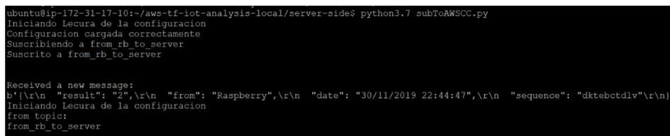
Figura 4.13: Consola de VPS EC2 de AWS suscrito al servicio MQTT AWS IoT Core recibiendo un mensaje enviado desde la Raspberry
