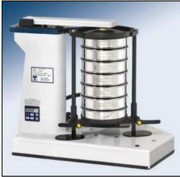
Figura 3 Ro-Tap, herramienta donde que agitan los tamices y se separan los granos de la muestra de acuerdo a su tamaño.
