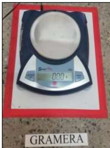
Figura 4 Balanza, utilizada para pesar la muestra tomada de cada una de las estaciones.
