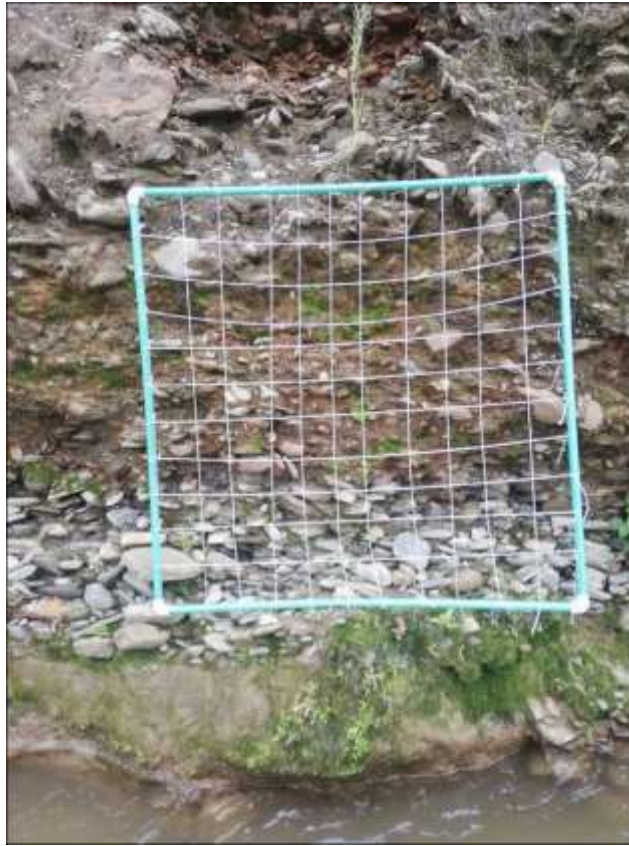
Figura 2 Malla de puntos empleada en el conteo de clastos tamaño grava en el campo.
