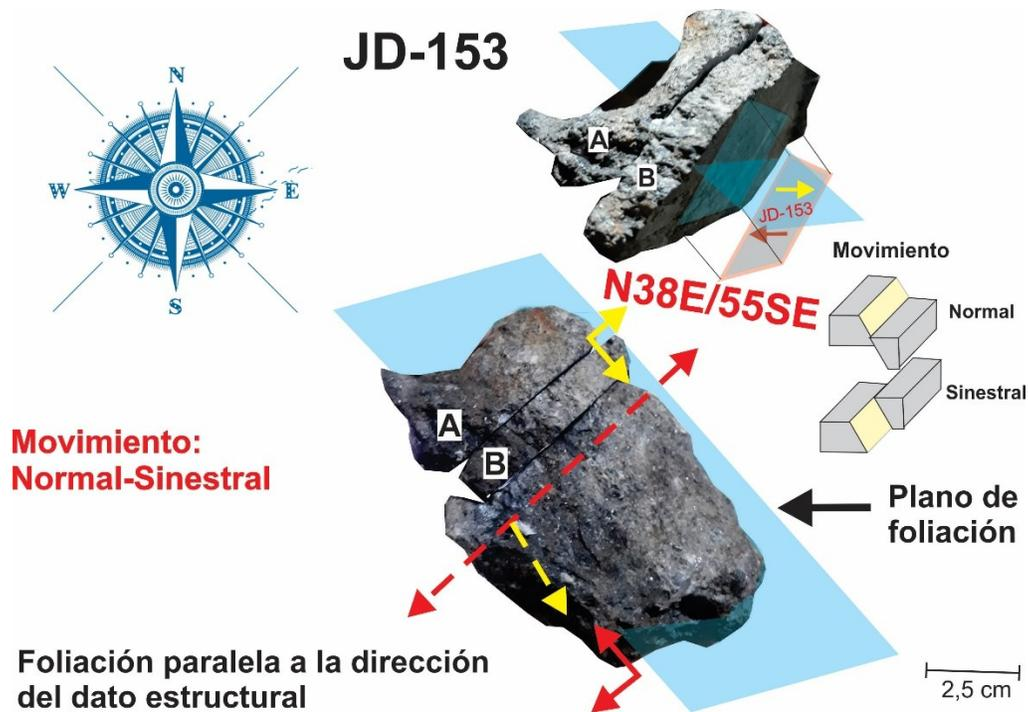
Figura 87. JD153, movimiento en sección delgada (destral) trasladado a muestra de mano orientada. Cinemática en el afloramiento, normal-sinistral.
