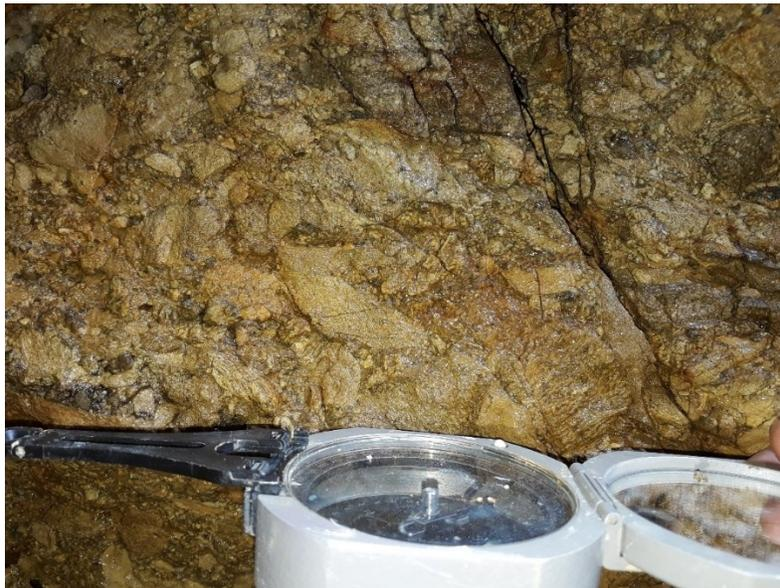
**Figura 20. Toba con deformación frágil, presenta una matriz triturada con remanentes de Líticos Volcánicos fracturados, expresando formas angulares. Sector de la Sultana-Río Olivares, cerca de la reserva Río Blanco.**
