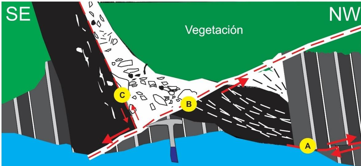
Figura 60 (A) Falla inversa, nótese que el bloque yacente se desplaza hacia el occidente. (B) Falla normal. (C) falla subvertical inversa. Quebrada La Siria.
