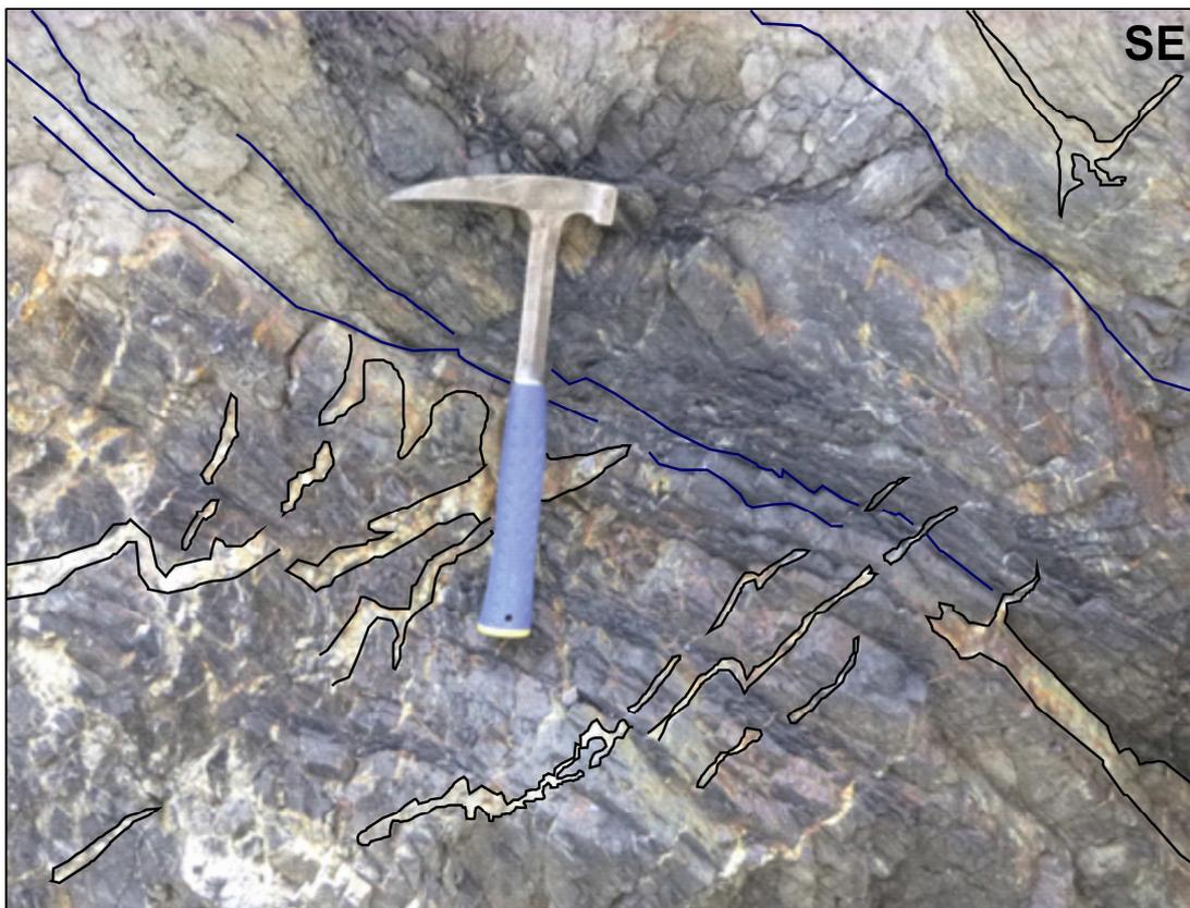
Figura 21. Zona de Falla. En negro se resalta las eyecciones cuarzosas; en medio, la zona de cataclasis.
