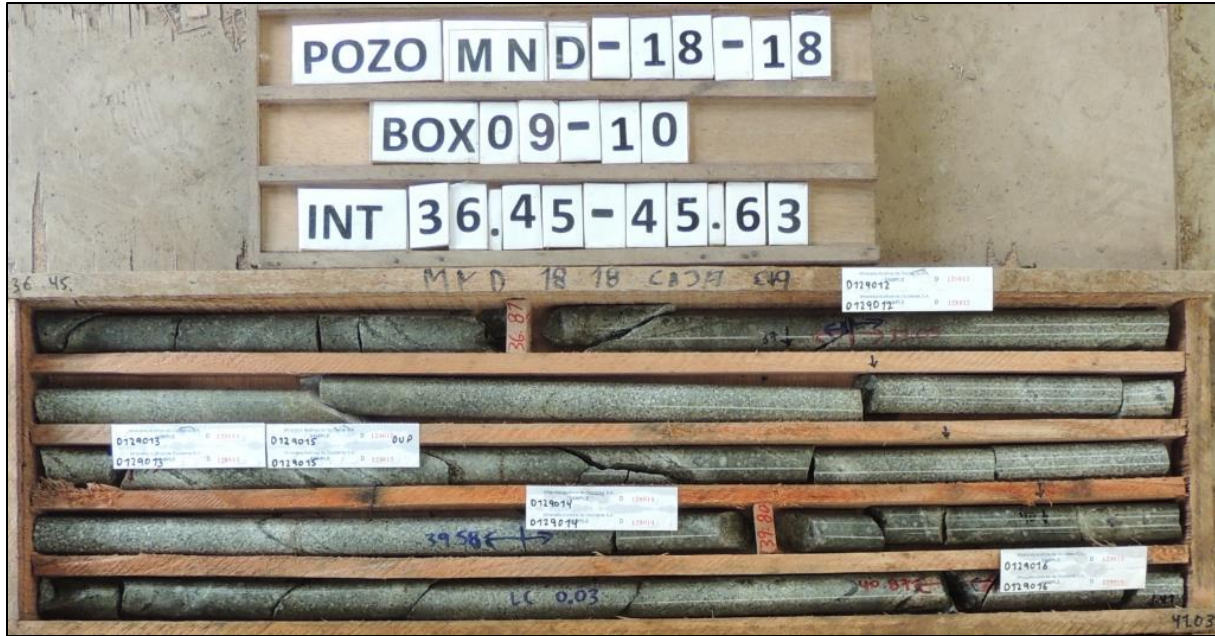
Figura 14. Pozo MND-18-18. Se observan las líneas azules que separan la muestra D129014, esta muestra va de 39.58 a 40.87 metros, debería tener 1.29 metros pero con una pérdida de 3 cm (LC 0.03) su longitud real en la caja es de 1.26m.
