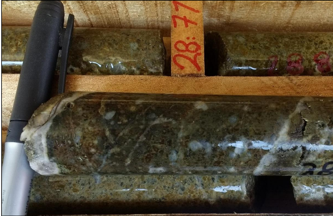
Anexo 13. Testigo de litología P1 (pórfido dacítico) con alteración argílica de smectita y presencia de venillas de cuarzo y pirita producto de una superposición del evento epitermal LS sobre el evento mesotermal provocando un reemplazamiento de pirrotina por pirita.
