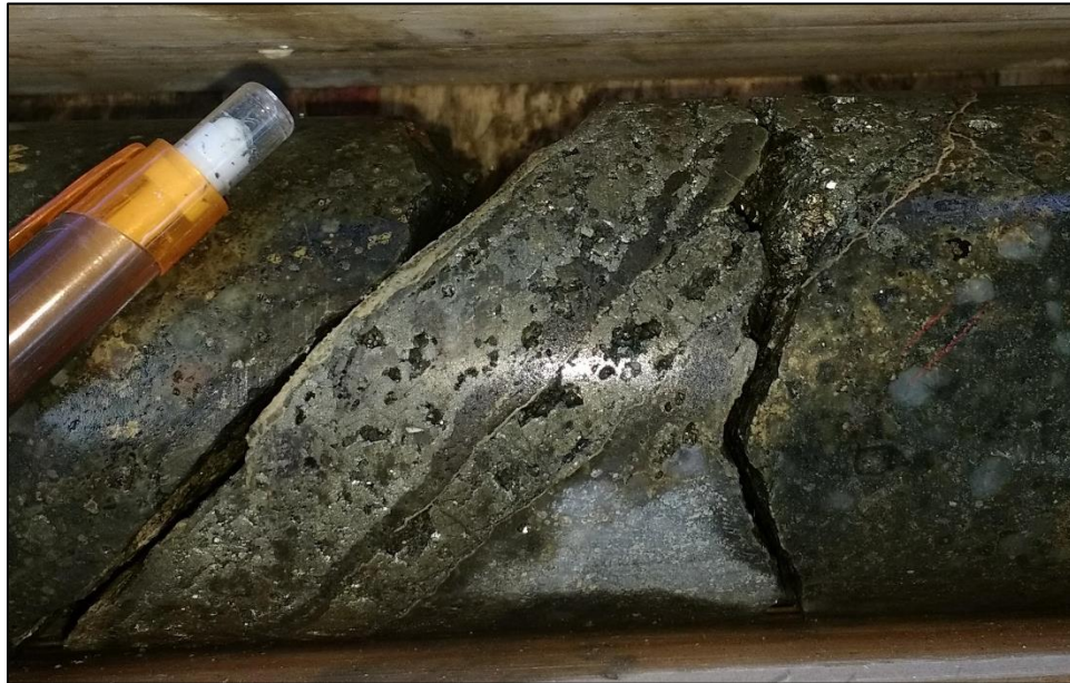
Anexo 18. Testigo de litología P1 (pórfido dacítico) con alteración argílica de illita-smectita y una vena epitermal LS de pirita.
