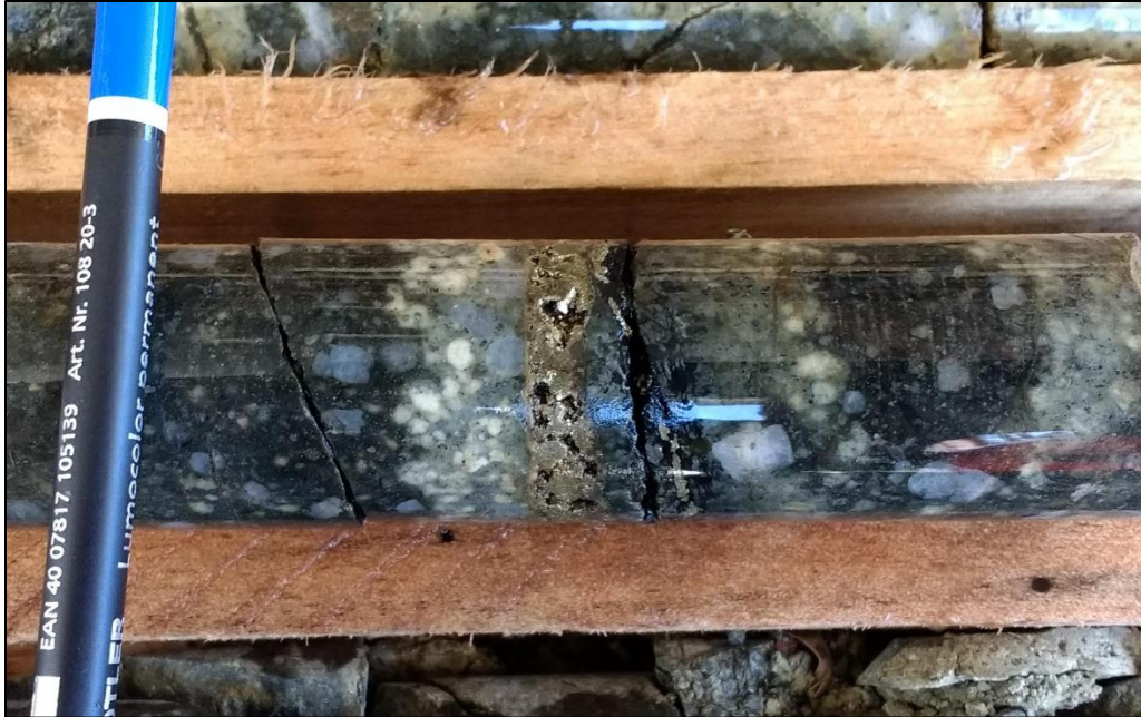
Anexo 19. Testigo de litología P1 (pórfido dacítico) con alteración argílica de smectita y una venilla de pirita producto del evento epitermal LS.
