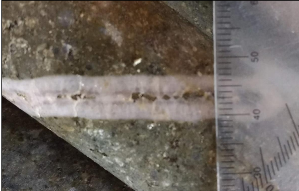
Anexo 15. Venilla de cuarzo pirita en testigo de litología P1 (pórfido dacítico) con alteración argílica de illita-smectita; la mineralogía de la venilla corresponde al evento epitermal LS que se superimpuso a una venilla de tipo mesotermal de cuarzo y pirrotina, la pirrotina ha sido reemplazada por pitita.
