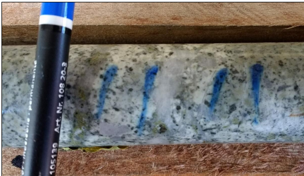
Anexo 16. Testigo de litología P1 (pórfido dacítico) con alteración propilítica de tipo pervasiva y venillas mesotermales de cuarzo con muy bajas cantidades de pirrotina y/o calcopirita, relacionadas a las venillas se observa alteración de albita de color blanco.
