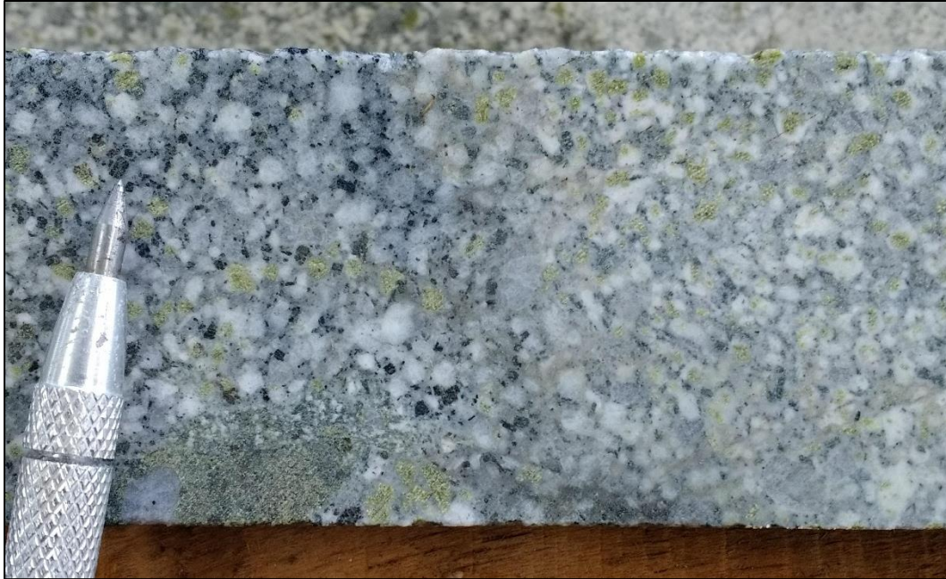
Anexo 11. Testigo de litología P1 (pórfido dacítico) con alteración propilítica de estilo pervasiva.
