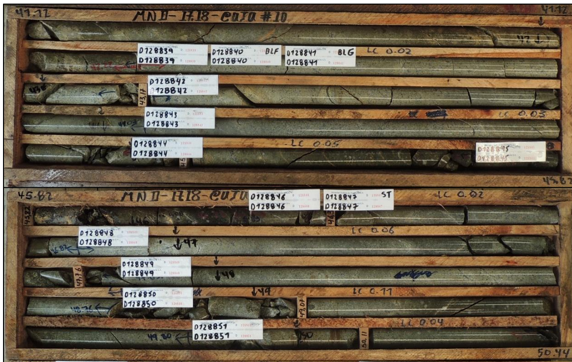
Figura 15. Se observan las muestras D128844, D128845 y D128846, en donde se realizó el muestreo de una veta y sus respaldos con dimensiones no mayores a 50 cm. La veta corresponde a la muestra D128845.
