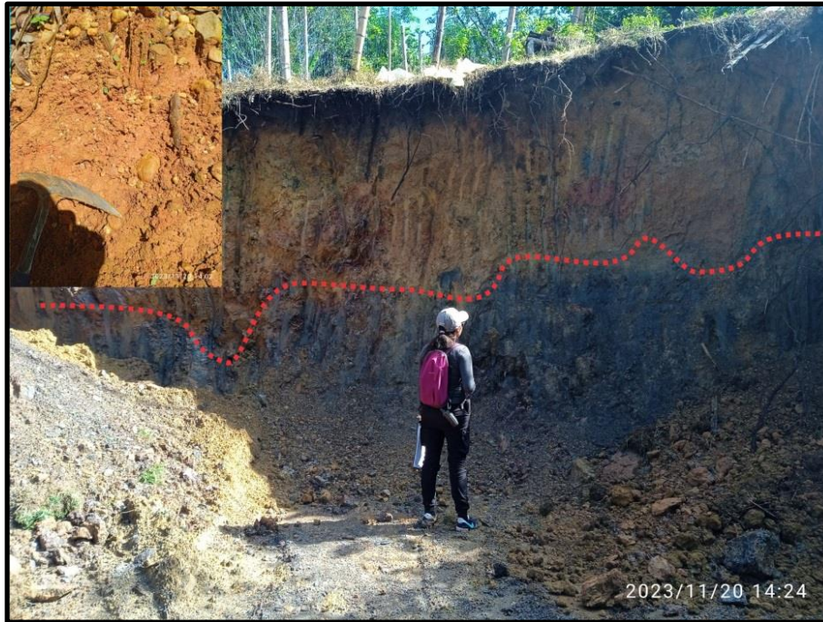
Figura. 18. Suelo residual limo arenoso plástico de roca sedimentaria de Grupo Honda (Srlaprsgh), tomado del equipo consultor 2024.
