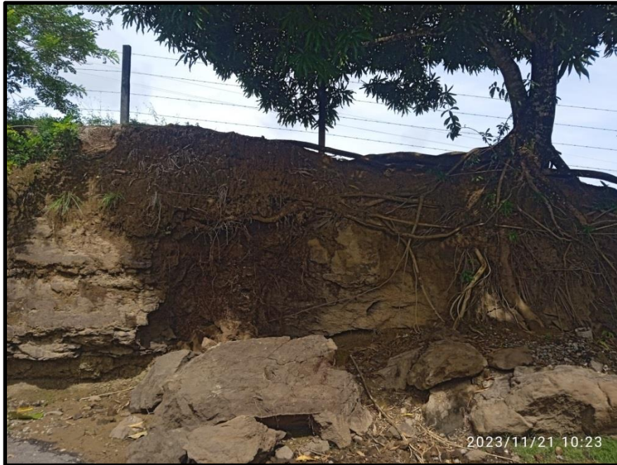
Figura. 20. Suelo transportado arena limoso húmedo de depósito coluvial. (Stalhdrc), tomado del equipo consultor, 2024.
