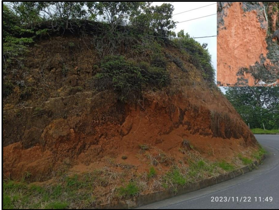
Figura. 17. Suelo residual arenoso húmedo de roca sedimentaria de la formación Mesa (Srahrsfm), tomado del equipo consultor 2024.
