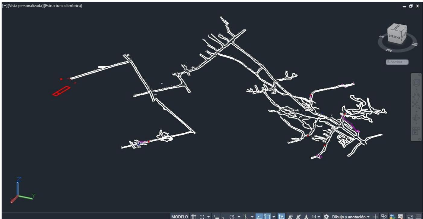
**Figura 41.** Levantamiento topográfico en 3D en AutoCAD de la mina Matrona; fuente propia.
