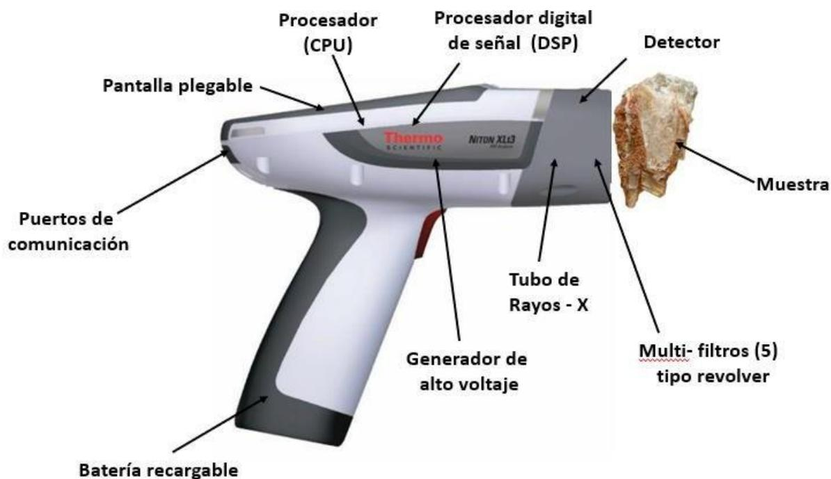
*Figura 56.* Dispositivo Niton XL3T; tomado y modificado de [www.technologywg.com/niton-xl3/](http://www.technologywg.com/niton-xl3/).
