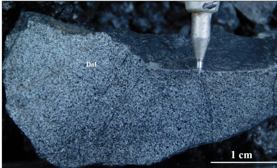
**Figura 32.** Shale dolomitizado en el pozo *ATD-0204*. Profundidad: 203.00 m. Abreviatura de nombre mineral tomada de Whitney & Evans (2010).
