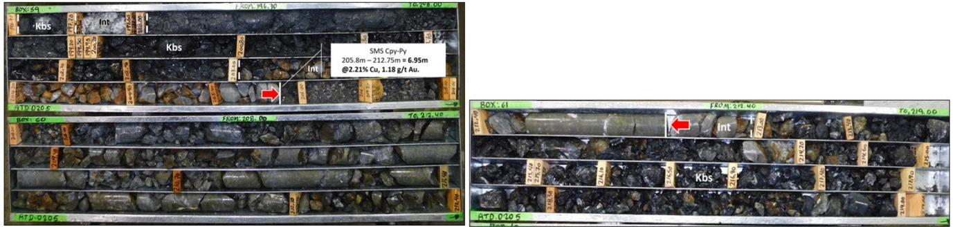
**Figura 40.** Leyes de Cu y Au del pozo *ATD-0205*. Se interceptó 6.95 metros de sulfuro semimasivo de calcopirita y pirita. (Kbs = chert negro, Int=intrusivo)
