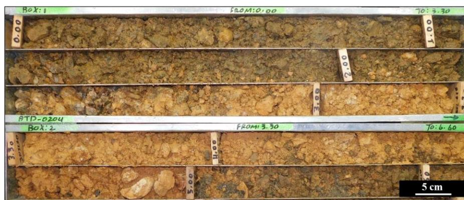
**Figura 23.** *ATD-0204*. Depósito coluvial. Compuesto por fragmentos angulares de tamaño guijarro (4-64mm) de chert gris en matriz limoarcillosa. Profundidad: 0.00 m a 5.60 m. Rocas sedimentarias (Kss)
