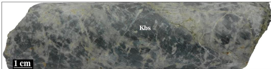
**Figura 15.** Brecha hidrotermal (HBx). Fragmentos de chert negro (Kbs) cementados en una matriz silíceica. Pozo ATD-0247 a 28.90 m.
