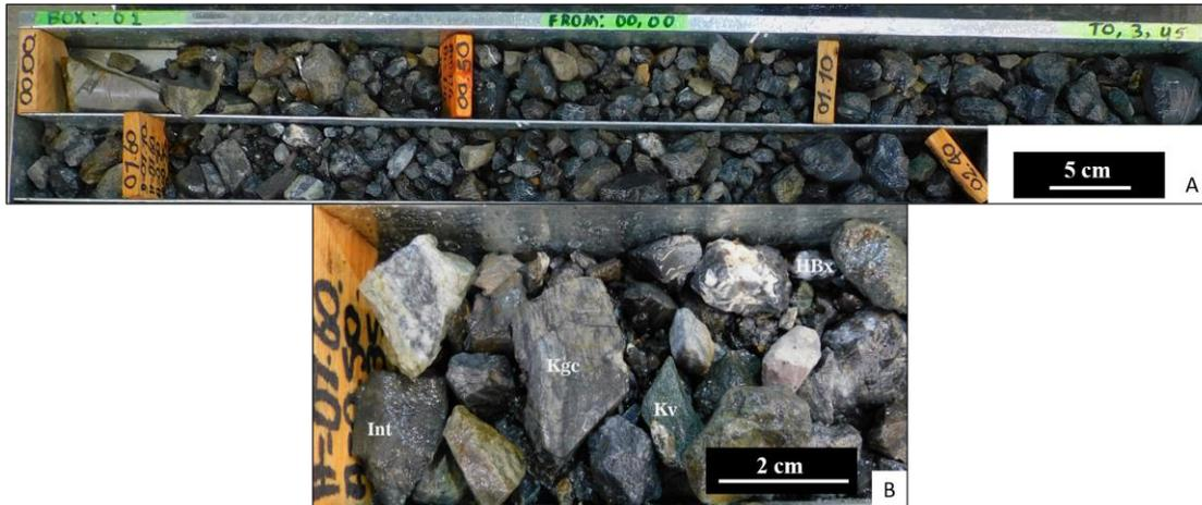
**Figura 17.** Antrópico (Ant). A) Recuperación de 2.40 metros de relleno antrópico. Pozo ATD-0227 entre 0.00 m y 02.40 m. B) Zoom de A en 01.60 m. Mezcla de fragmentos de intrusivo (Int), chert gris (Kgc), basalto (Kv) y brecha hidrotermal (HBx).
