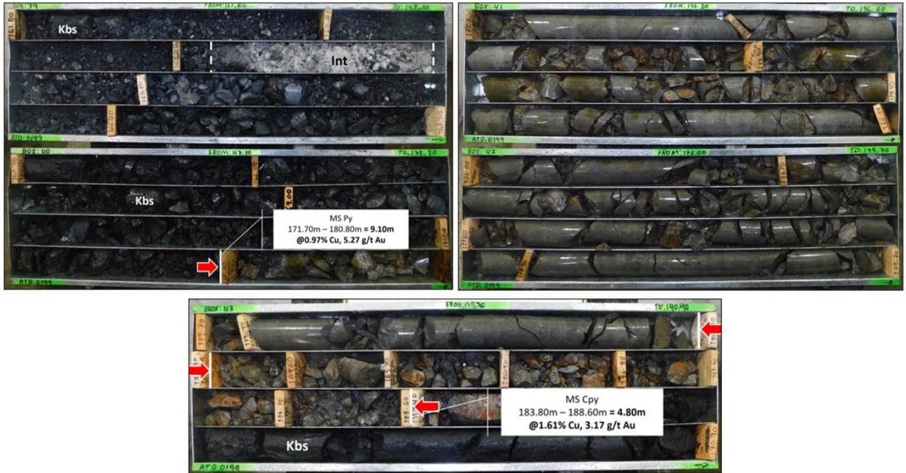
**Figura 38.** Leyes de Cu y Au del pozo *ATD-0199*. Se interceptó 9.10 metros de sulfuro masivo de pirita y posteriormente 4.80 metros de sulfuro masivo de calcopirita. (Kbs = chert negro, Int=intrusivo).
