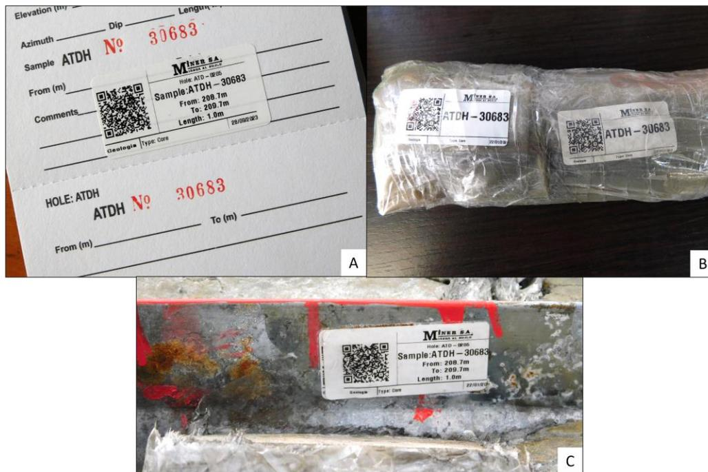
**Figura 21.** Método de muestreo de núcleos de perforación. Muestra ATDH-30683 del pozo *ATD-0205*. From: 208.70 m to:209.70 m. A) Tiquete en talonario de muestreo. B) Ejemplo de embalaje de una muestra. C) Tiquete en la caja de almacenamiento, la línea roja indica el principio de la muestra.
