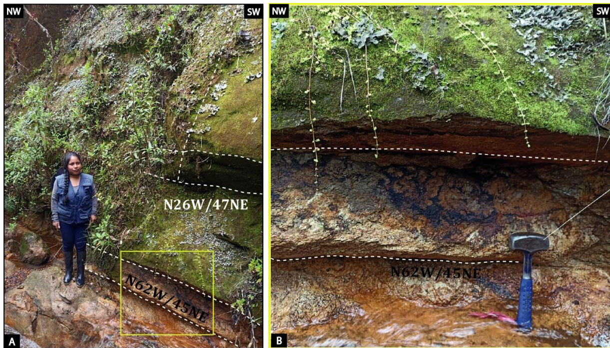
Figura 24. Diaclasas en afloramiento rocoso característico al norte del volcán Campanero ( 1^{\circ}08'35''N , 77^{\circ} 6'42''W ); se observa la orientación preferencial NW-SE de las diaclasas.
