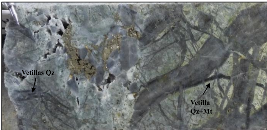
Figura 49. LLCO_006. Vetillas de cuarzo, cuarzo (Qz)+magnetita (Mt) en stockwork sobre clastos de cuarzodiorita media. Profundidad 107.40m.
