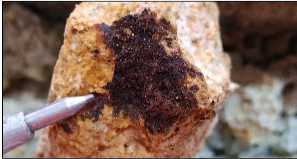
Figura 34. LLCO_005. Óxidos de Hierro (hematita-goetita) en parche, con textura boxwork, en diorita media (QM). Profundidad: 08.50m.
