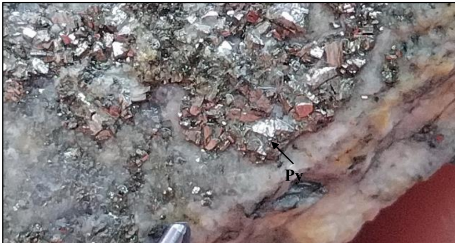
Figura 42. LLCO_006. Pirita (Py) masiva en cuarzodiorita media con sericita fuerte. Profundidad: 31.25m
