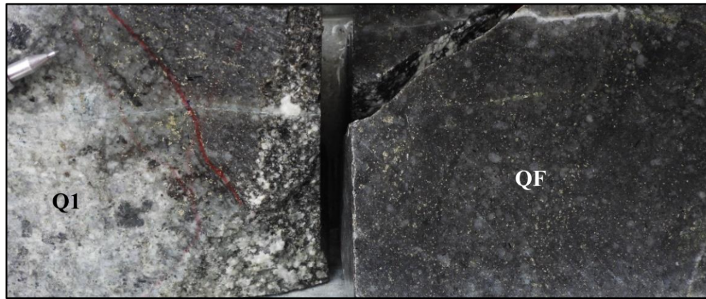
Figura 66. Contacto entre Q1 (Izq) y QF (Der). Pozo LLCO_005. Prof: 289m.
