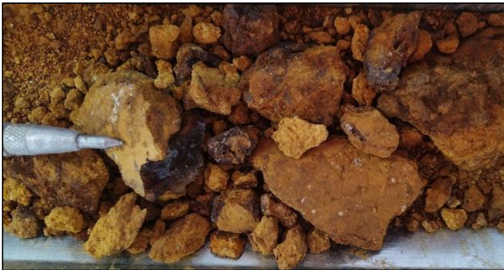
Figura 35. LLCO_005. Óxidos de Hierro en parches sobre saprolito rocoso de diorita media (DM). Profundidad: 08.10m.
