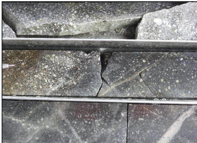
Figura 78. Alteración hidrotermal pozo LLCO_005. Clorita en vetillas mm y parches (parte superior e intermedia), sericita moderada (parte superior e intermedia) y biotita secundaria en masa fundamental en QF (parte inferior). Intervalo 128m-131m.
