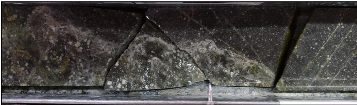
Figura 72. Contacto intrusivo entre QM (Izq) y QF (Der) con vetillas mm subparalelas de carbonatos. Pozo LLCO_001. Prof: 83.65m.
