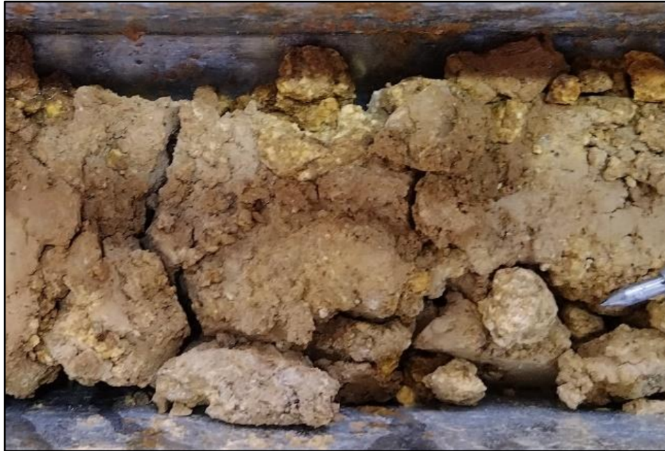
Figura 25. LLCO_010. Saprolito limo-arcilloso, con fragmentos de diorita. Profundidad 08.00m.
