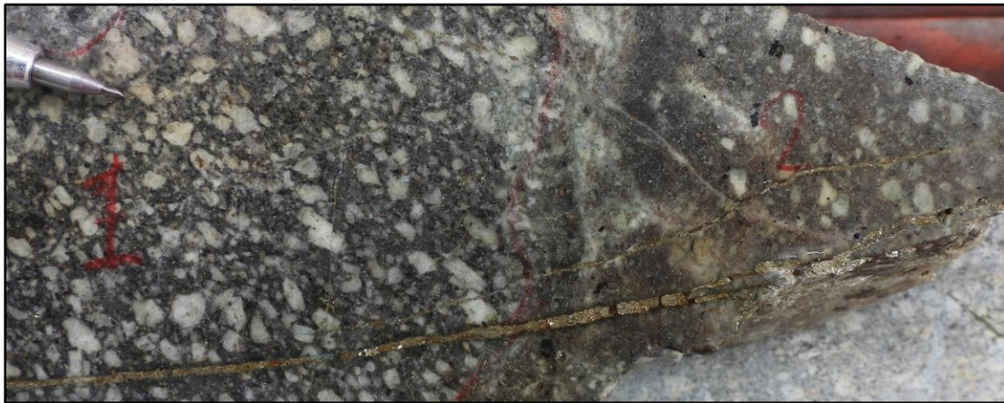
Figura 70. Contacto intrusivo entre QG (Izq.#1) y QM (Der. #2), ambas unidades cortadas por vetilla de Py con borde de Mt. Pozo LLCO_005. Prof: 129.50m.
