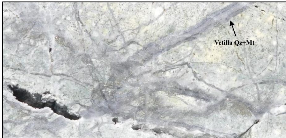
Figura 50. LLCO_006. Stockwork de vetilla de cuarzo (Qz)+ magnetita (Mt) y sulfuros sobre cuarzodiorita media con sericita pervasiva fuerte. Profundidad: 115.35m.
