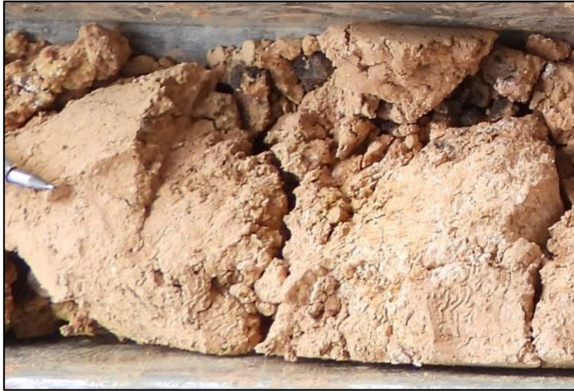
Figura 32. LLCO_005. Alteración supergena en saprolito. Profundidad: 02.00m
