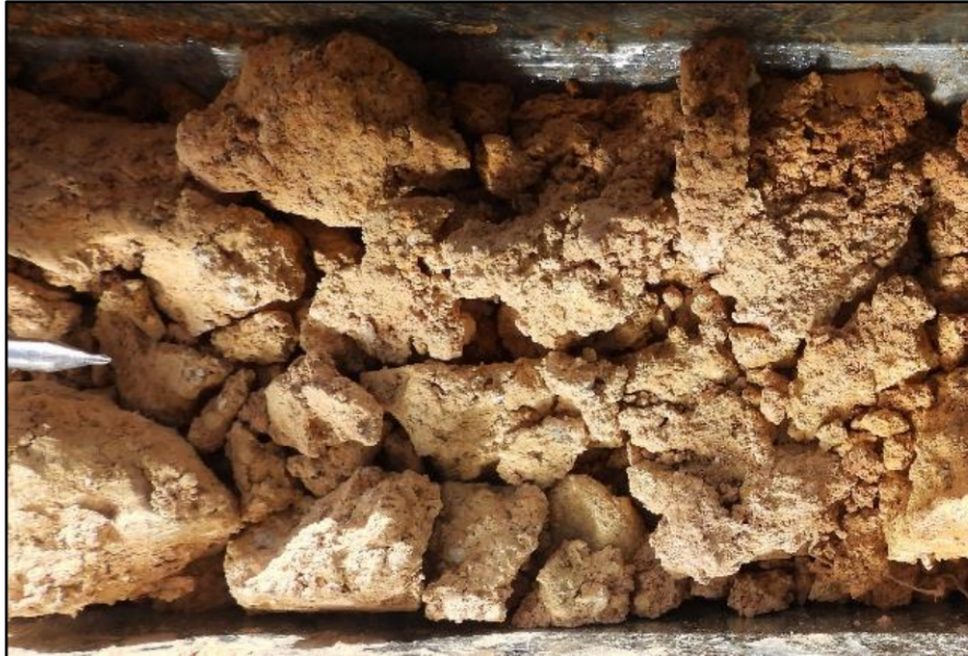
Figura 33. LLCO_005. Alteración supergena en saprolito. Profundidad 03.00m
