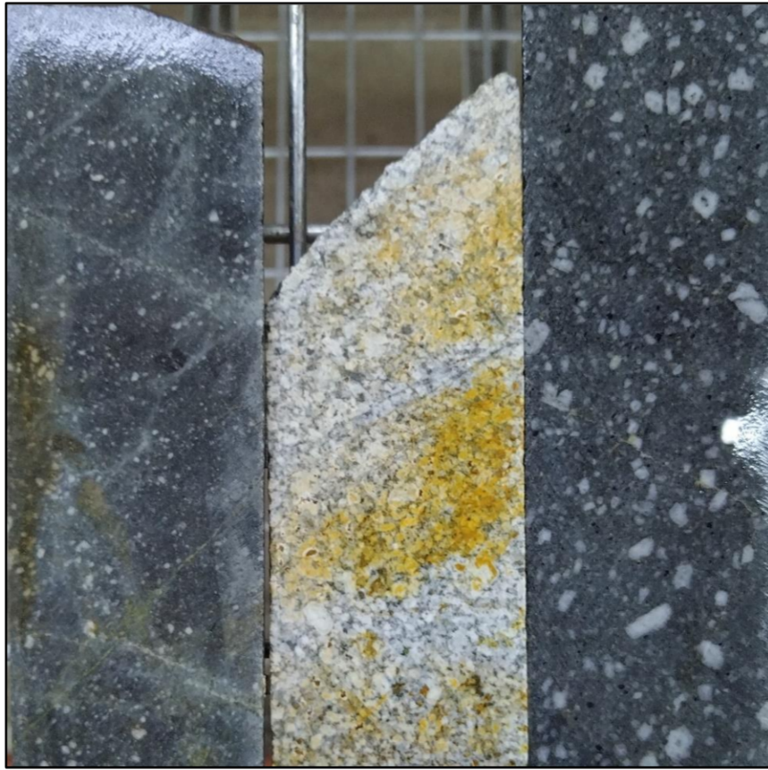
Figura 77. Comparativo de Dioritas presentes en el pozo LLCO_001. De izquierda a derecha: DF con biotita secundaria en masa fundamental (Prof: 83.80m), DM con sericita moderada-fuerte (Prof: 48.80m), DG con biotita secundaria en masa fundamental (Prof: 224.10m).
