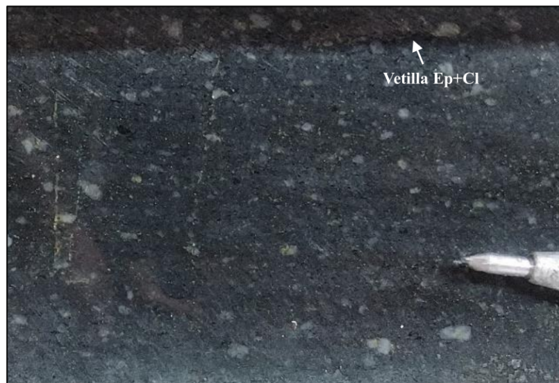
Figura 9. LLCO_005. Cuarzodiorita fina (QF) presenta mayor porcentaje de masa fundamental que minerales, epidota (Ep)+clorita (Cl) en vetillas mm (profundidad: 301.50m).
