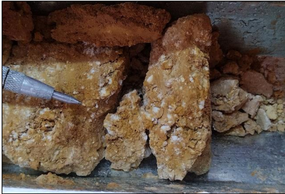
Figura 26. LLCO_010 Saprolito rocoso, con sericita fuerte (diorita) y FeOX (supergena). Profundidad: 12.50m.
