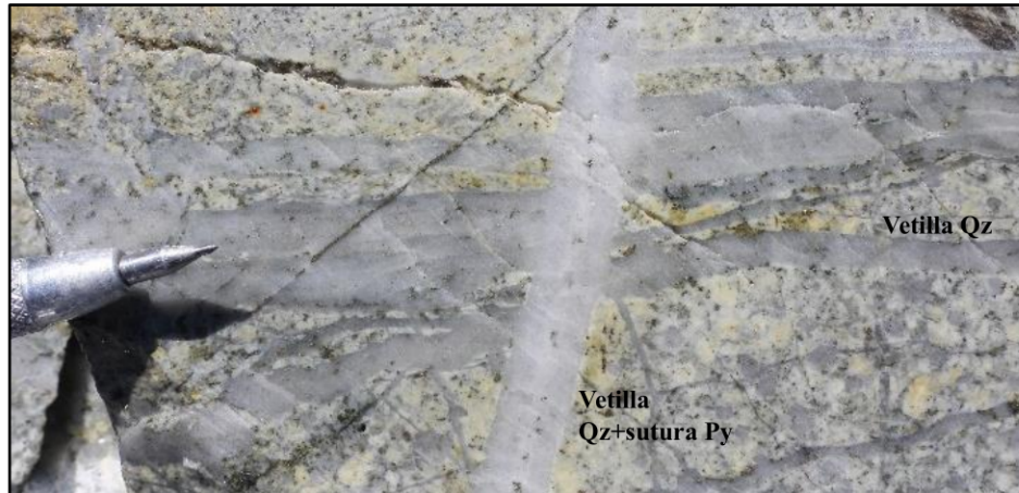
Figura 51. LLCO_010. Vetilla de cuarzo (Qz) con sutura de pirita (Py) cortando vetillas de cuarzo subparalelas en diorita media con sericita pervasiva fuerte. Profundidad: 206.00m.
