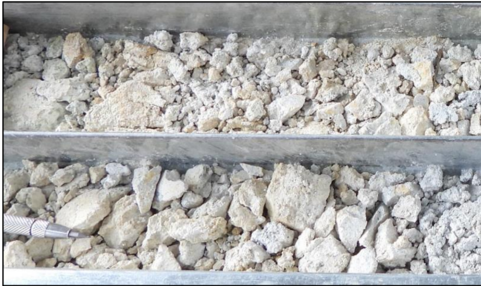
Figura 59. LLCO_005. Falla (BXT). Roca triturada y molida con sericita pervasiva fuerte controlada por la estructura. Profundidad: 85.30m.
