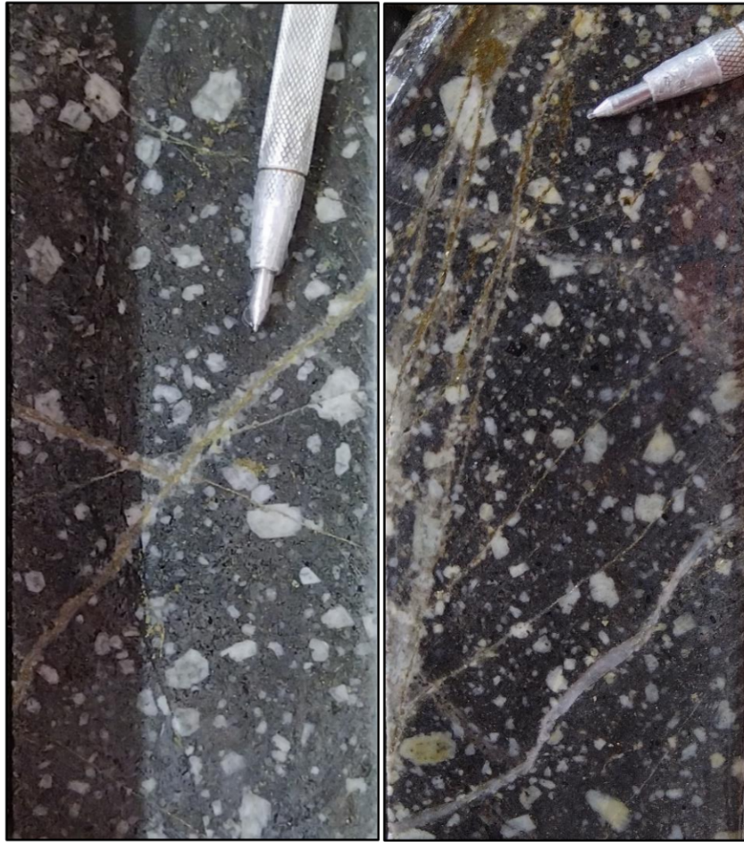
Figura 69. Izq. DG (Diorita Gruesa) con magnetita en masa fundamental, vetilla de clorita+sericita cortando vetilla de igual composición. Pozo LLCO_001. Prof: 225.80m. Der. QG (Cuarzodiorita Gruesa) con vetillas rectas de Py y vetillas sinuosas de Qz+Cb. Pozo LLCO_005. Prof: 25.15m.
