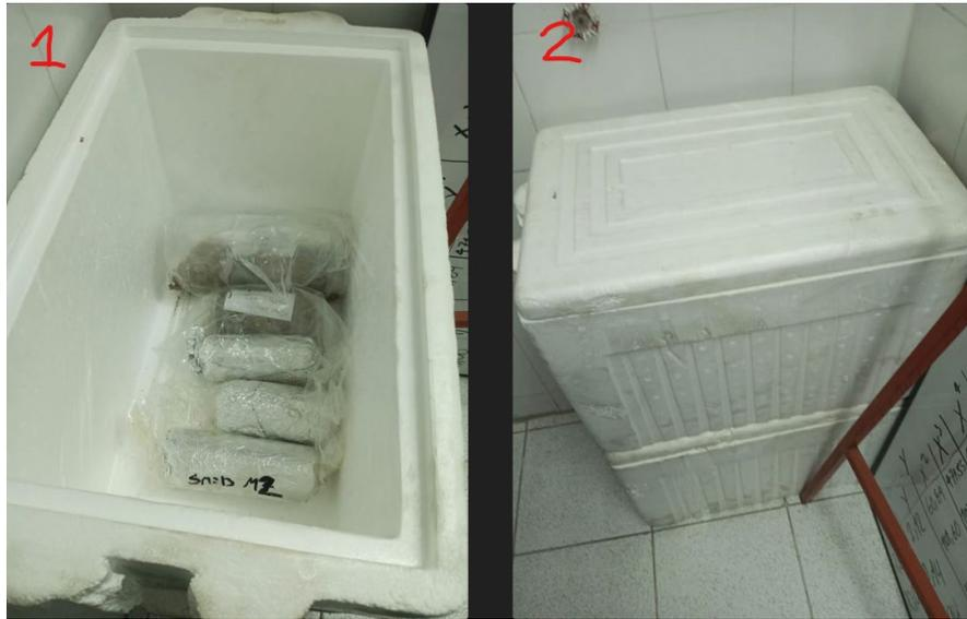
*Figura 30 En la imagen uno se muestra las muestras recubiertas con parafina, papel aluminio y plástica para reducir al máximo la pérdida de humedad. La imagen dos corresponde a el recipiente de transporte de las muestras en la que no existen variaciones de temperatura y humedad. Fuente: Elaboración propia (2023).*
