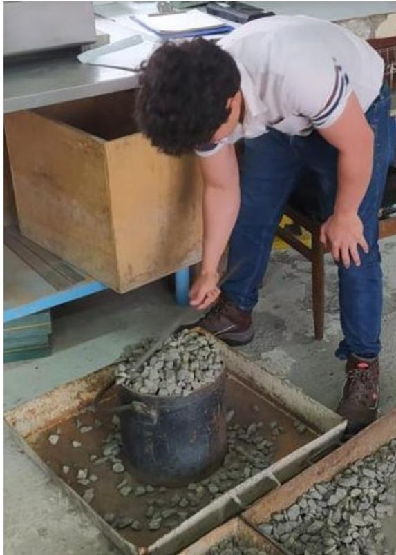
*Figura 24 Demostración de procedimiento para determinar la densidad bulk de un agregado mineral. Fuente: Elaboración propia (2023).*
