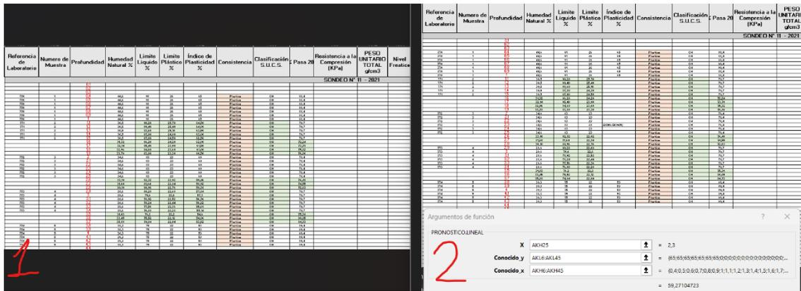
Figura 67 Comparación de los resultados obtenidos a partir de la interpolación de los datos. En la imagen uno se presenta en la celda seleccionada los valores obtenidos a partir de los ensayos de humedad natural y en la imagen dos los valores obtenidos a partir de la interpolación lineal. Elaboración: Fuente propia (2023).
