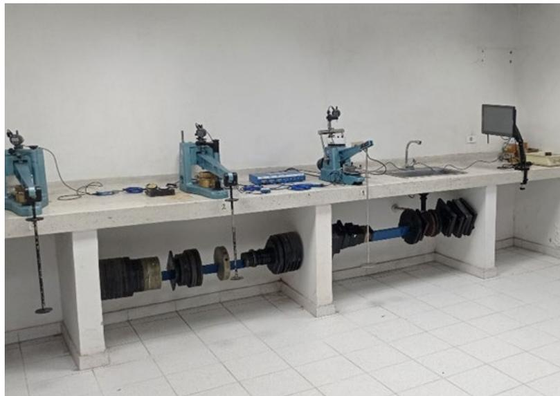
*Figura 23 Equipo instrumental para el hallazgo del índice de colapso o consolidometro. Fuente: Elaboración propia (2023).*
