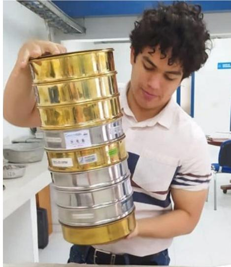
*Figura 19 Ejemplo de disposición de tamices para determinación de tamaño de grano. Fuente: Elaboración propia (2023).*
