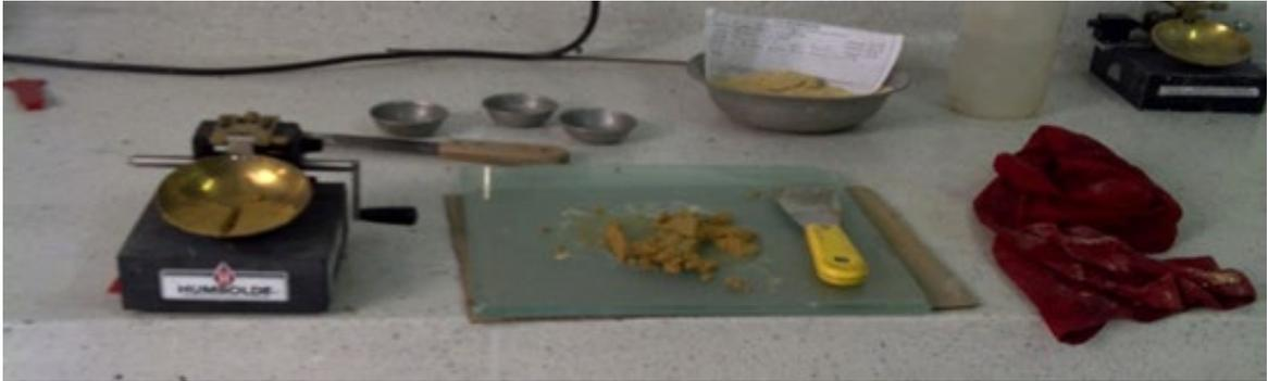
Figura 22 Ejemplo de herramientas y procedimiento del ensayo limite líquido. Fuente: Elaboración propia (2023).
