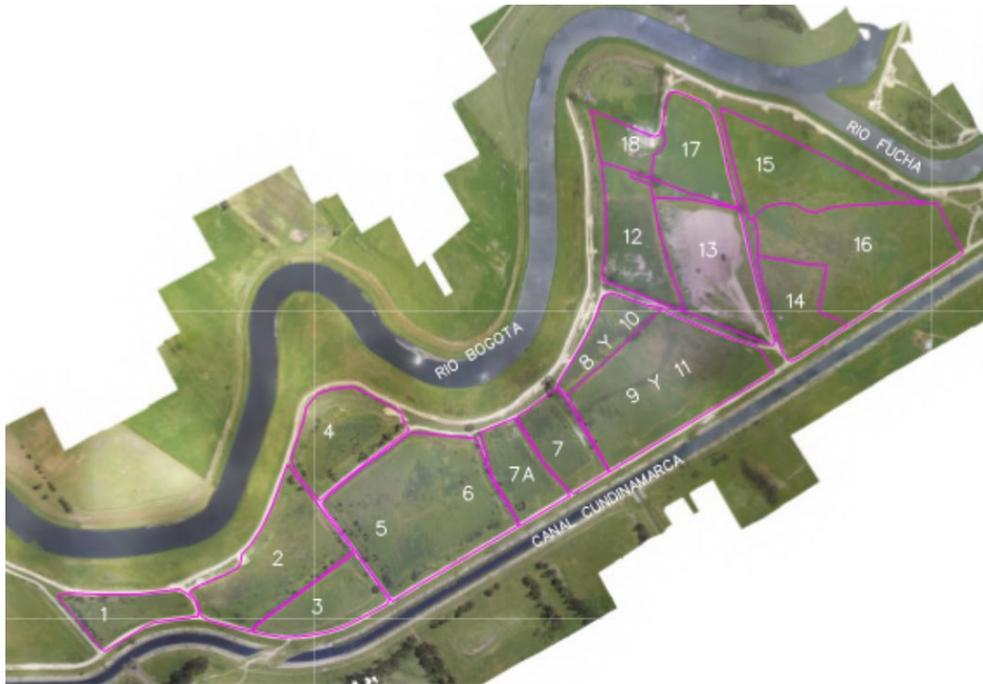
Figura 3 Celdas de disposición en el predio La Magdalena. Fuente: (Empresa de Acueducto y Alcantarillado de Bogotá - ESP, 2020).
