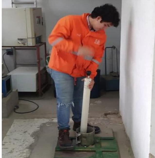
*Figura 18 Procedimiento de compactación de muestra de suelo en molde fijo para ensayo Proctor. Fuente: Elaboración propia (2023).*
