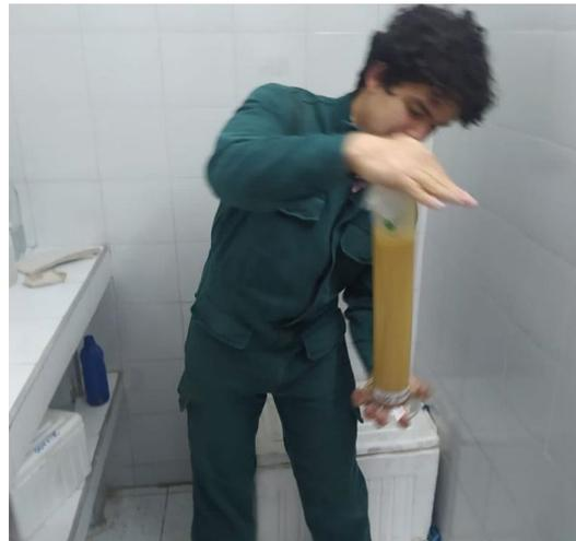
*Figura 20 Procedimiento de ahitamiento para análisis granulométrico por método del hidrómetro. Fuente: Elaboración propio (2023).*
