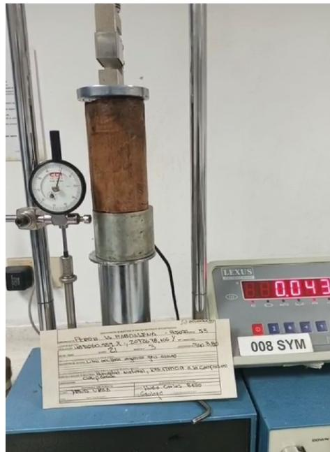
*Figura 21 Demostración de ensayo de para determinación de la resistencia a la compresión inconfiada de una muestra de suelo. Fuente: Elaboración propia (2023).*
