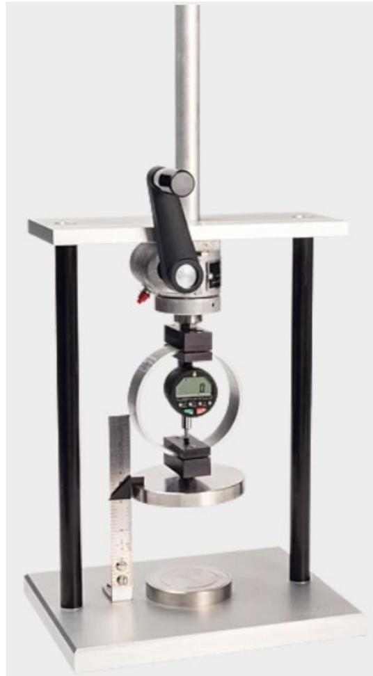
*Figura 14 Equipo de prueba de compresión no confinada. Tomado de (Humboldtmg, 2023)*
