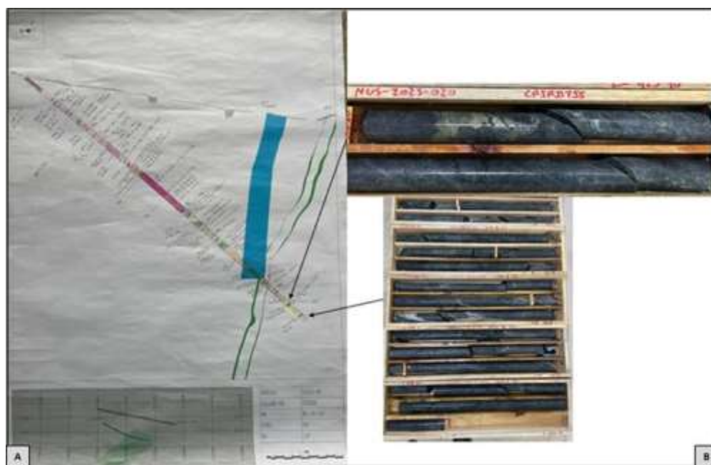
Figura 43.. En la imagen se observa vista de perfil del pozo NUS-2023-020, se observan las estructuras encontradas entre 423.1m y 445.2m, A) Vista de perfil del pozo en plano a escala 1:500. B) Muestras de núcleos encontradas entre 423.1m y 445.2m de profundidad. (ver tabla 2). (Fuente: autor)
