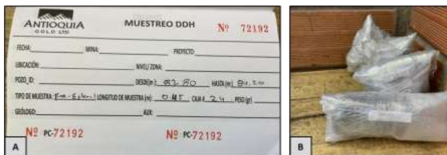
Figura 46. A) Formato para la asignación de muestras y sus consecutivos, en este se pone la profundidad en la que es tomada la muestra, una longitud y un peso para cada muestra individual. (Fuente: Antioquia Gold LTDA)
