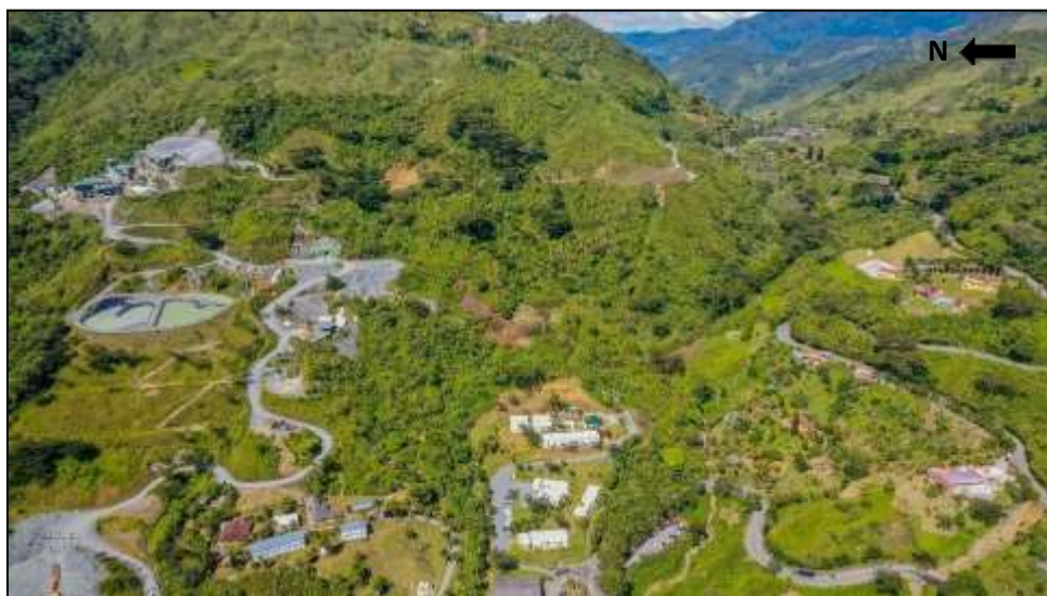
Figura 4. Vista desde el aire de la mina Guayabito, se observa gran parte de la operación principal del proyecto, en la cual se observa la planta de beneficio en la parte más superior, piscinas sedimentadores, la boca mina, taller, zonas de campamentos y oficinas y acopio de esteril. (Fuente: Yessid Acevedo).
