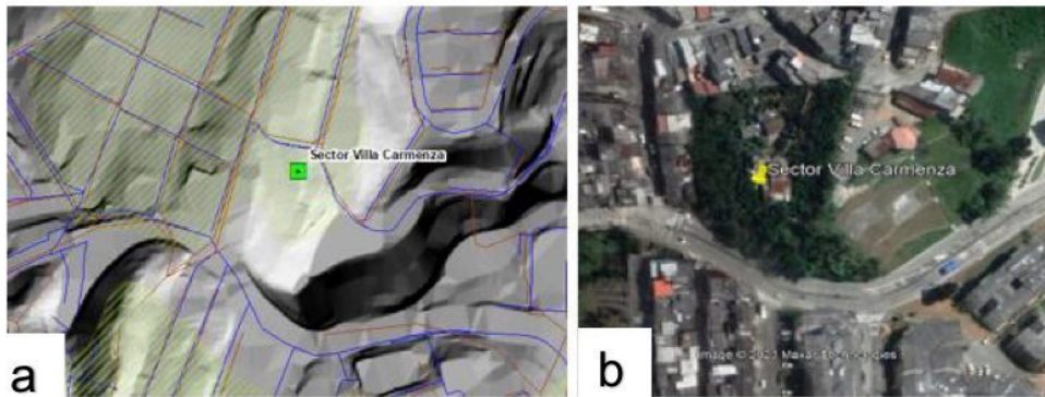
Figura 8. a). superpuesto de Zona de alta pendiente, lleno antrópico y redes de servicio público. b) Imagen satelital, de la localización del punto en cuestión. Elaboración propia y tomado de Google Earth, 2022.
