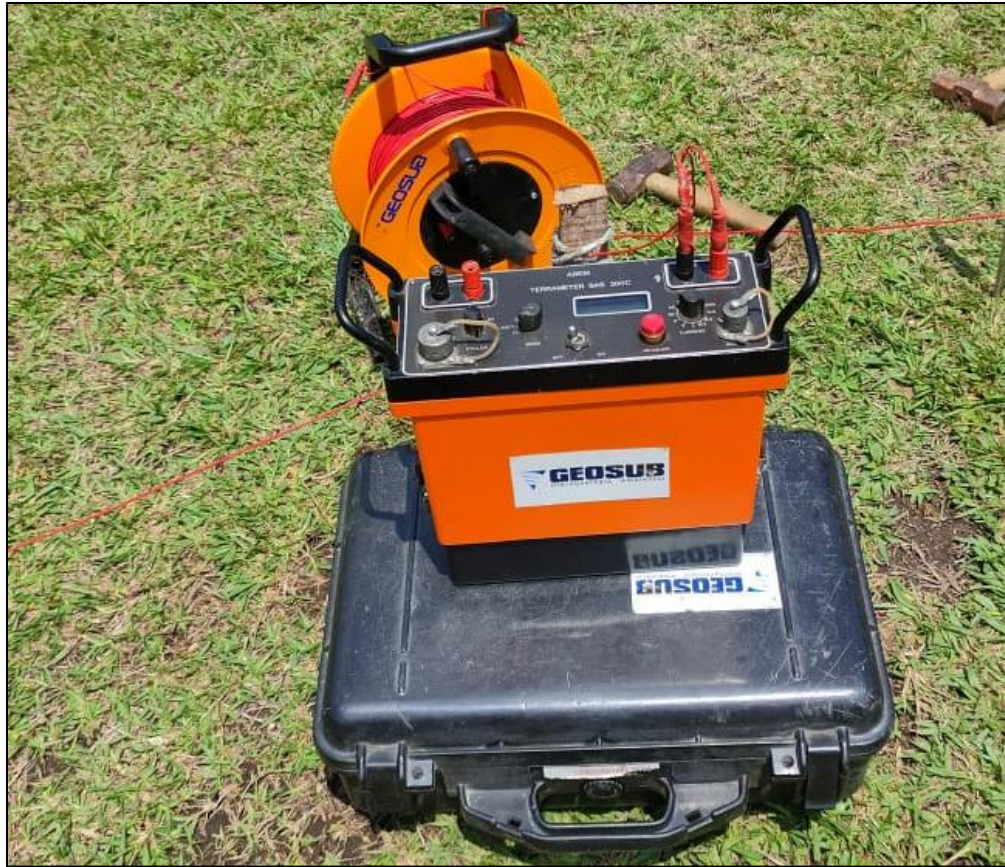
Figura 11. Equipo Terramer ABEM SAS 300 C.
