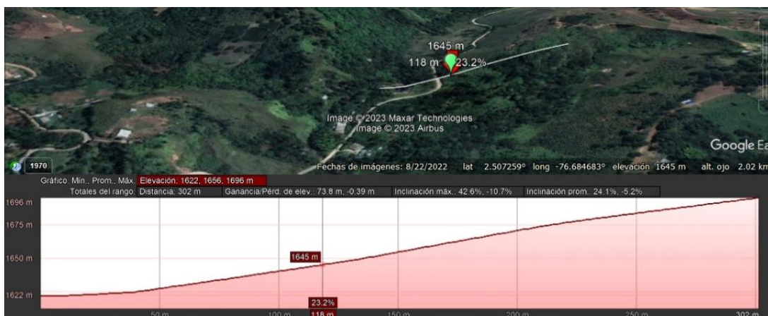
Figura 9. Pendiente del terreno en la zona denominada como DES 1, Vereda La Meseta.
