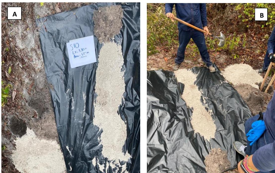
Figura 12. A) Codificación acordada con su respectiva profundidad para las perforaciones a realizar. B) Perforación con paladraga en el proceso de muestreo.
