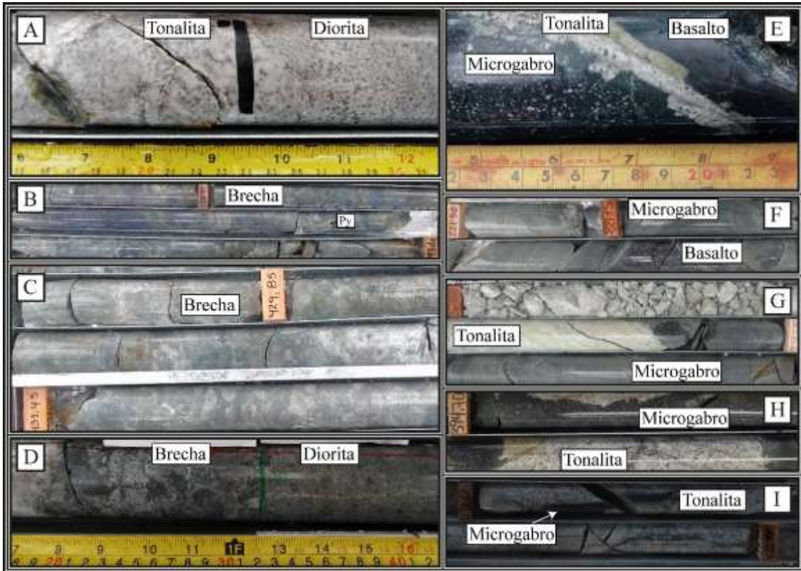
Figura 17. A: Contacto intrusivo planar entre tonalita y diorita. Pozo GBUS008D01, 141,35 m de profundidad. B: Brecha hidrotermal con matriz mineralizada de pirita, Pozo BUSY392, 791 m de profundidad C: Brecha intrusiva con clastos de la tonalita, en un matriz de composición andesítica. Pozo BUSY395, 428 m de profundidad D: Contacto transicional entre una brecha y una diorita. Pozo BUSY395, 829,9 m de profundidad. E: Contactos intrusivos entre microgabro, tonalita y basalto. Pozo BUSY401, 376 m de profundidad. F: Contacto intrusivo entre microgabro y basalto de textura porfirítica. Pozo BUSY 401, 222,6 m de profundidad. G: Contacto intrusivo entre tonalita y microgabro. Pozo BUSY401, 251,2 m de profundidad. H: Contactos intrusivos entre microgabro y tonalita. Pozo BUSY401, 395,7 m de profundidad. I: Diques intrusivos del microgabro en la tonalita. Pozo BUSY401, 422 m de profundidad.
