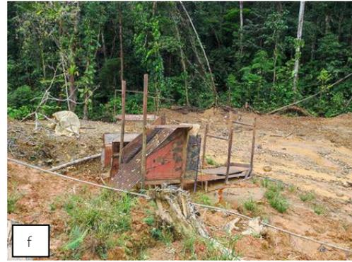
Nota. Maquinaria obtenida durante visitas de control y vigilancia por las Fuerzas Armadas y Policiales y profesionales a cargo de la autoridad ambiental. En la fotografía a) y b) se puede observar balsas utilizadas para el dragado de los sedimentos en el cauce del río, c) y d) motobombas y tuberías utilizadas durante la operación minera y e) y f) clasificadoras que sirven para la separación del oro de los sedimentos. Tomado de CORPOAMAZONIA, 2022.
