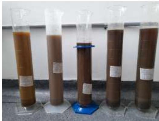
Después se dejaba reposar la muestra durante dos horas, se insertaba nuevamente el hidrómetro y se tomaban los datos para así calcular los porcentajes de arcillas en la muestra de suelo; y, por último, el porcentaje que restaba para completar el 100 % de la muestra que correspondía a la cantidad de limos que había en la muestra de suelo, (Foto de laboratorio 05).
