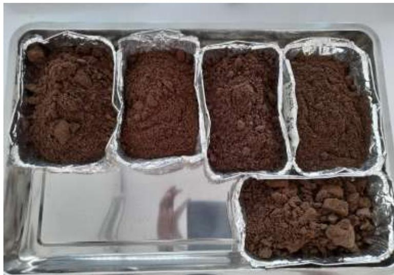
Primero se procedió poner las muestras de suelo que tenían un peso entre los 500 y 800 gramos en unas bandejas de aluminio, para después secar las muestras de suelo en el horno de secado THERMO Electron Corporation, modelo 6530, a una temperatura de entre 90° a 100°C, durante un lapso de tiempo de 24 horas, (Foto de laboratorio 02).
