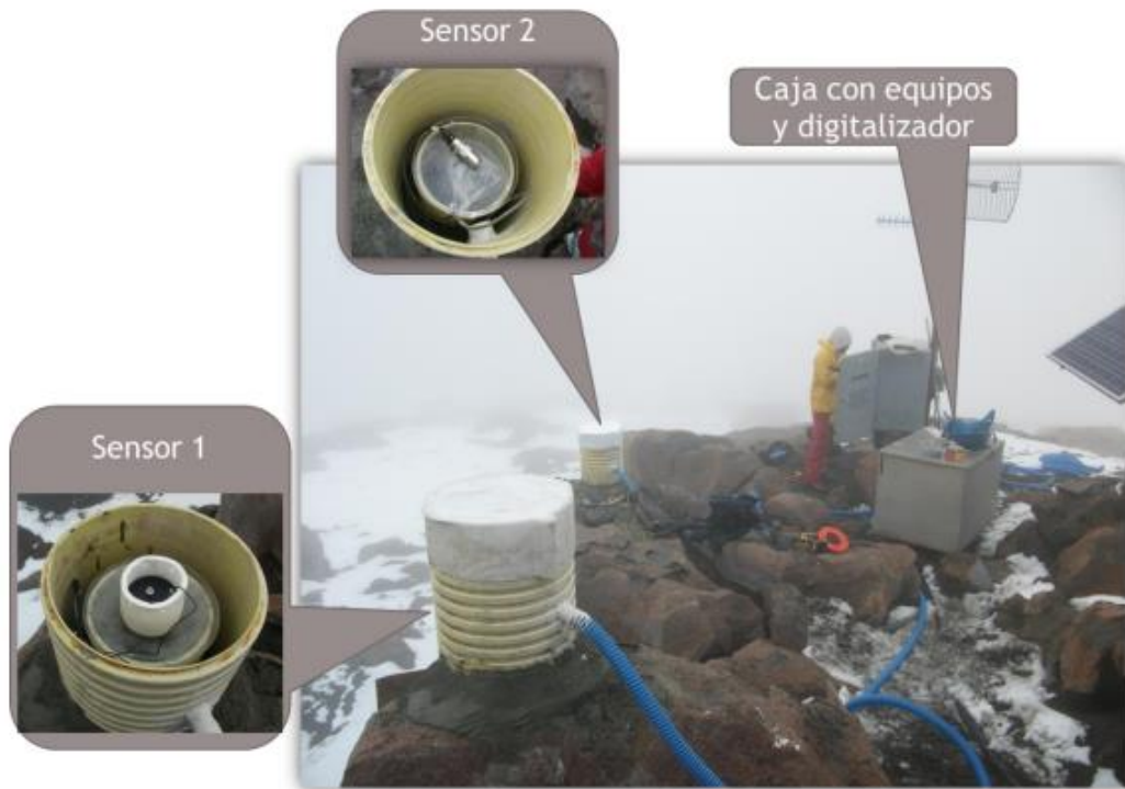
Figura 10. Estación ACOLM-VNR, pares de sensores acústicos y caja con digitalizador. Tomado de Ospina, 2019.
