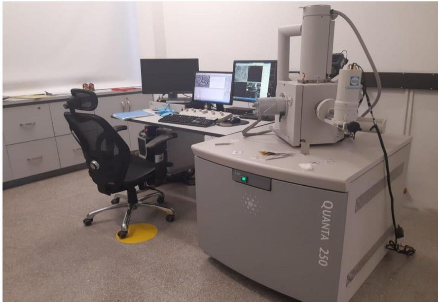
**Figura 24.** Fotografía del Microscopio Electrónico de Barrido (MEB) del Instituto de Investigaciones en Estratigrafía (IIES) de la Universidad de Caldas.
