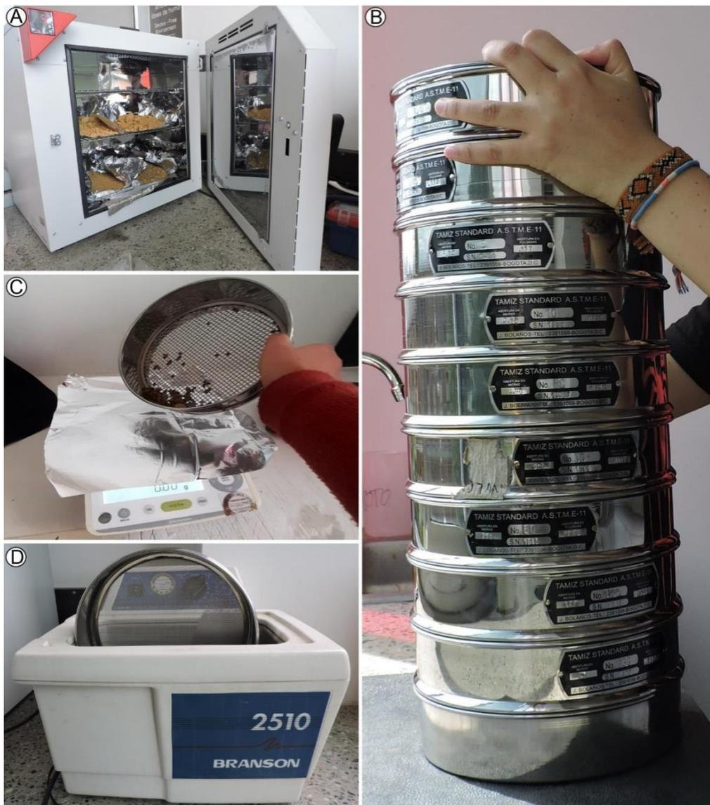
**Figura 19.** Representación del análisis granulométrico por el método del tamiz por vía seca. **A.** Horno de secado de las muestras. **B.** Representación del proceso de tamizado a mano. **C.** Pesado del material. **D.** Proceso de lavado para evitar contaminación.
