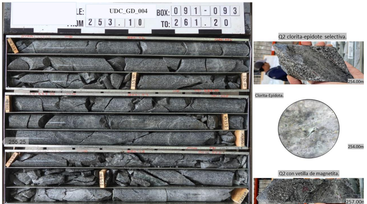
Figura 54. Caja 091 -093 - Cuarzodiorita con vetilla de magnetita y clorita- epidota selectiva. Fuente: propia.
