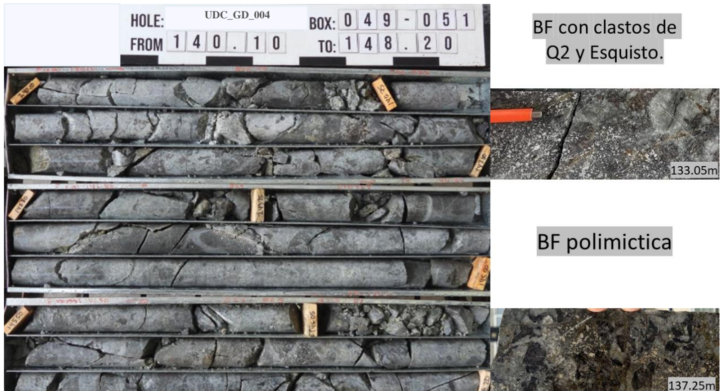
Figura 44. Caja 049 - 051 - Brecha polimictica clastosoportada con clastos de cuarzdiorita y esquito. Fuente: propia.
