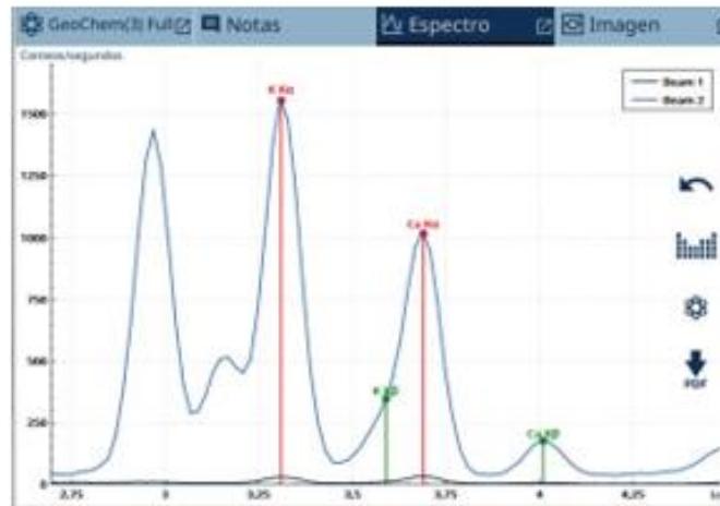
Ilustración 7. Espectro en el que el elemento K se sitúa en la "cresta" de la curva del "Beam 2" en el cual se cuantifica.
