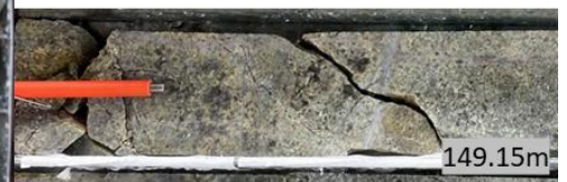
Figura 45. Caja 052-054 - Contacto entre brecha polimítica clastosoportada y cuarzodiorita. Fuente: propia.
