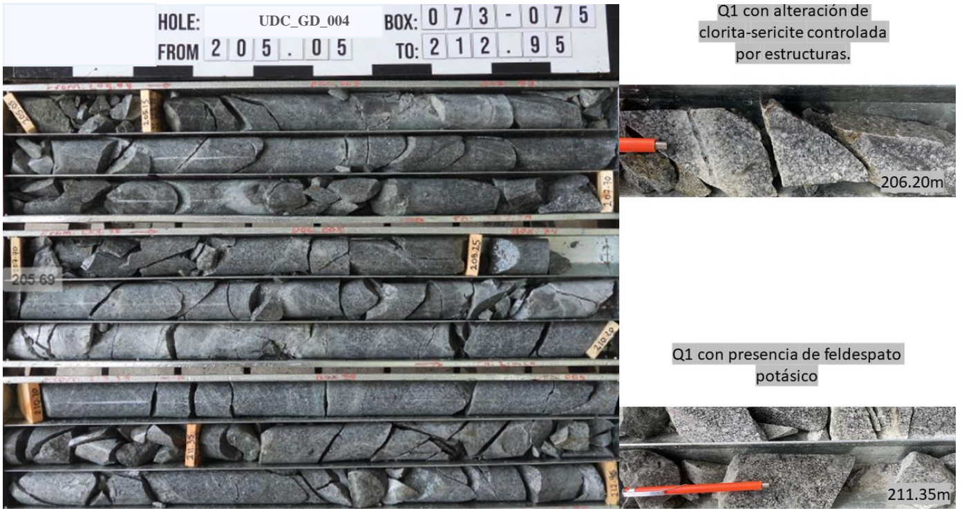
Figura 51. Caja 073 - 075 - Cuarzodiorita porfírica con alteración de Clorita-Sericita controlada por estructuras y presencia de feldespato potásico. Fuente: propia.
