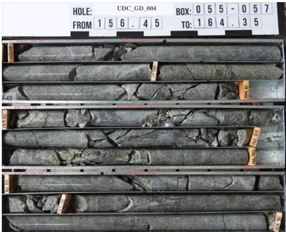
Figura 46. Caja 055 – 057 - Cuarzodiorita con vetillas tipo pórfido con halo de Sericita. Fuente: propia.
