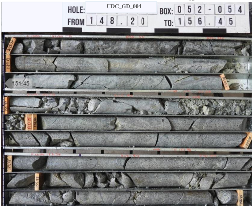
Figura 45. Caja 052-054 - Contacto entre brecha polimítica clastosoportada y cuarzodiorita. Fuente: propia.
