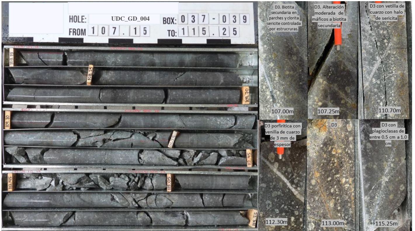
Figura 41. Caja 037-039 – Diorita porfirítica de grano fino con biotita secundaria y vetillas de cuarzo. Fuente: propia.
