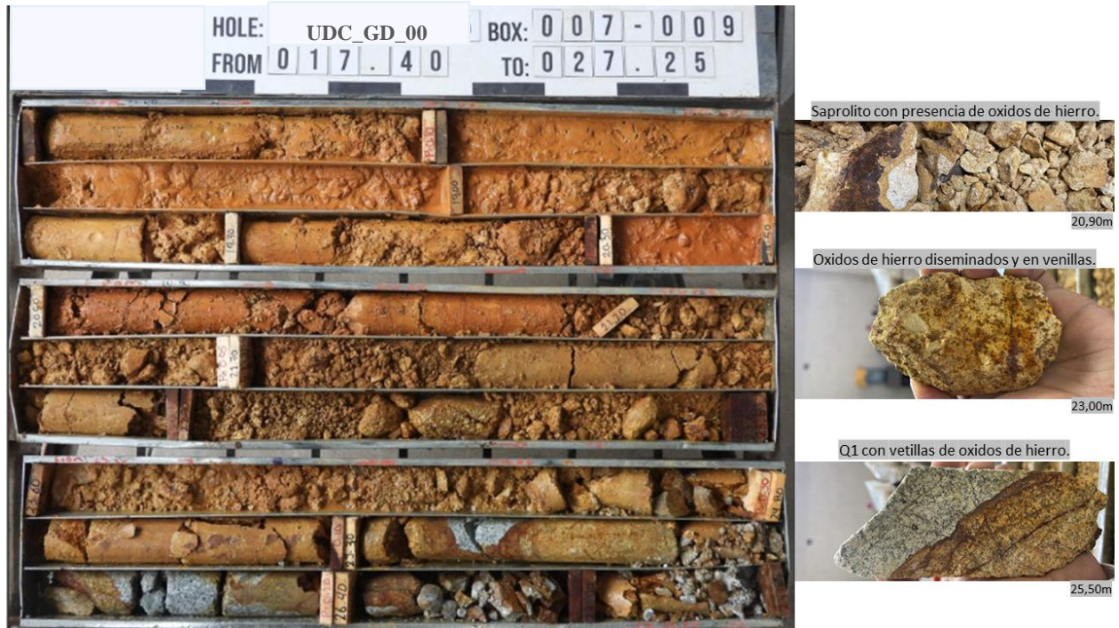
Figura 31. Caja 007-009 - Suelo residual y fragmentos del saprolito rocoso con alteración supergénica y concentración de óxidos de hierro. Fuente: propia.
