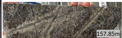
Figura 46. Caja 055 – 057 - Cuarzodiorita con vetillas tipo pórfido con halo de Sericita. Fuente: propia.
