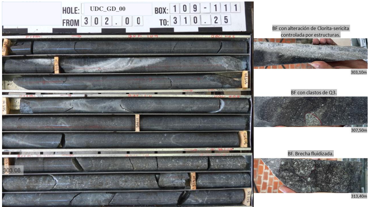
Figura 73. Caja 109 - 111 - Brecha polimíctica clastosoportada con alteración de Clorita- Sericita controlada por estructuras, clastos de Q3 y brecha fluidizada. Fuente: propia.
