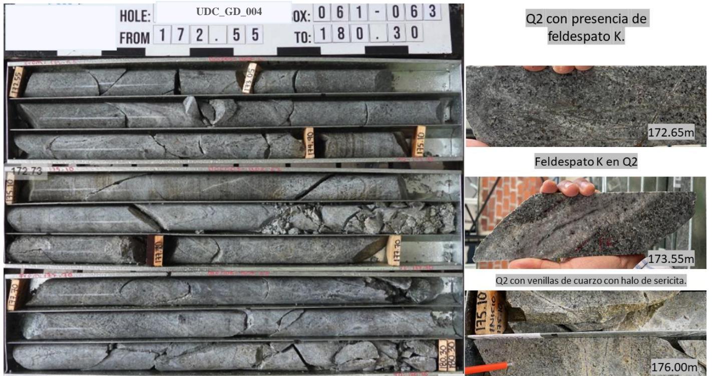
Figura 48. Caja 061 - 063 - Cuarzodiorita con presencia de feldespato potásico. Fuente: propia.
