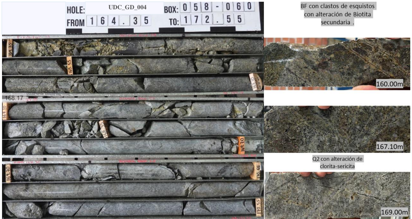
Figura 47. Caja 058 – 060 - Brecha polimítica clastosoportada con clastos de esquistos y Cuarzodiorita con alteración a Clorita-Sericita. Fuente: propia.
