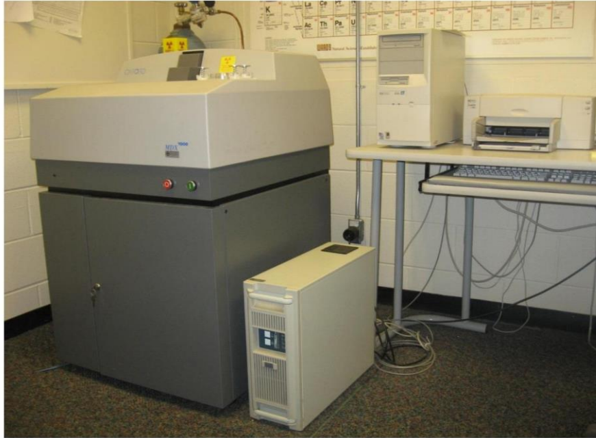
Figura 6. Analizador MDX1080+ MDXRF del instrumento Oxford de laboratorio. Tomado de: https://www.olympus-ims.com/es/landing/explore-vanta/
