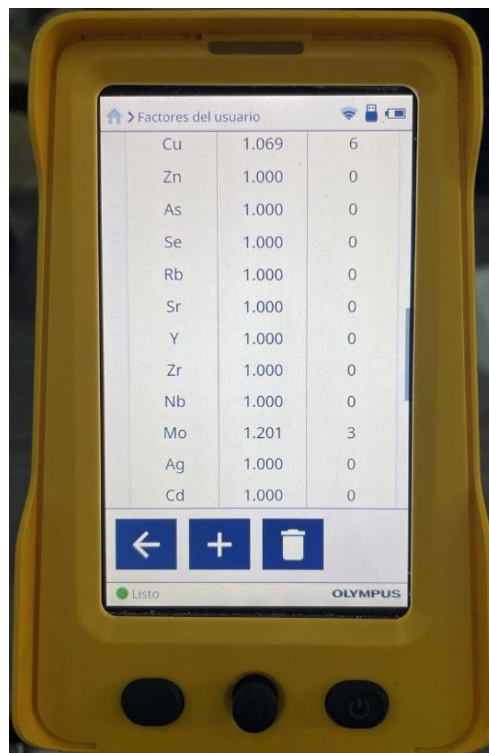
Figura 18. Factor de usuario creado en el equipo XRF-P para calibración del Cobre (Cu) en el que se ingresó el valor de m : 1,1069 y b : 6. Fuente: propia.
