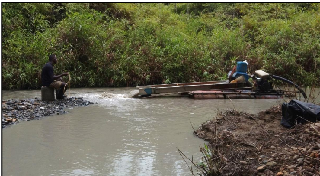
Figura 4. Técnica semi-mecanizada aplicada por la MAPE.
