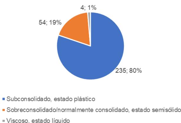
**Figura 36.** Estado de las muestras de suelo según su Índice de Liquidez.
