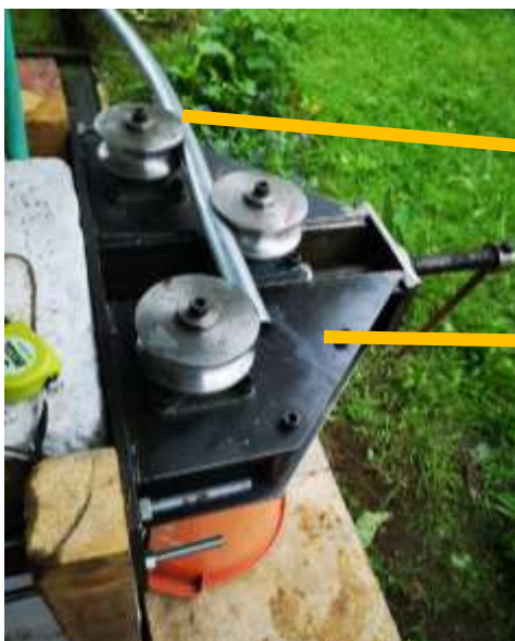
Figura 21: Máquina roladora de arcos, (Orozco Orjuela, 2021)
