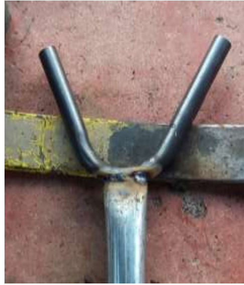
Figura 20: Poste con la carevaca soldada (Orozco Orjuela, 2017)
