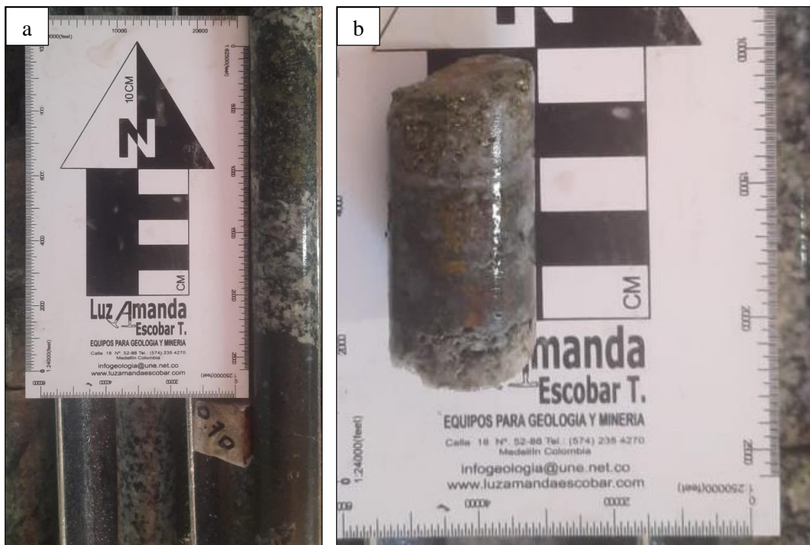
Figura 32.a. Segregación de minerales máficos en la roca caja del pozo 5. 32.b. Vetilla de cuarzo con pirita en cristales en pozo 5. (Fuente: autor)
