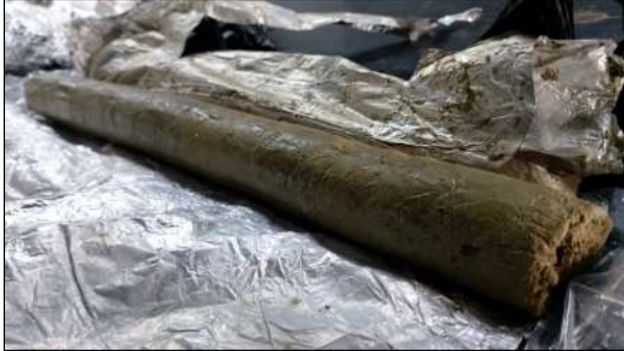
Figura 12 Muestra extraída por medio de un tubo shelby Nótese la geometría de la muestra tomada que corresponde a la forma del tubo con el cual se extrae Fuente: Laboratorio 2 Ríos Ingenierías S.A.S
