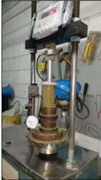
Figura 17 Equipo de laboratorio del ensayo de Compresión Simple Se aprecia la muestra que se va a someter a compresión, y en la parte superior la pantalla donde se controlan los valores de la presión.
