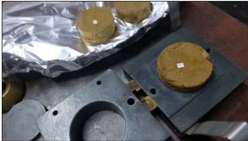
Figura 14 Muestras circulares para el ensayo de corte directo No consolidado-No drenado (UU) Nótese que las tres muestras del suelo son del mismo material y corresponden a la misma profundidad a la que se extrajo
