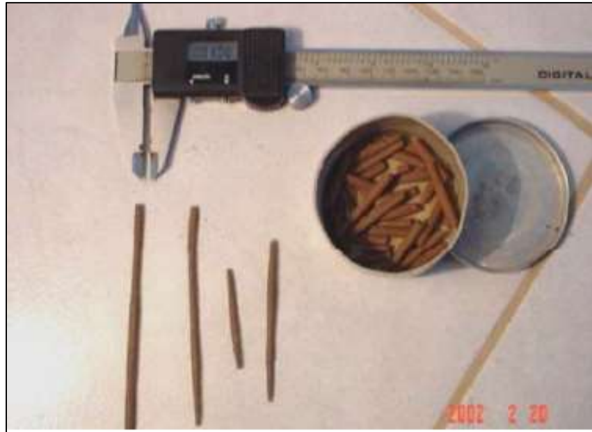
Figura 21 Enrollado del suelo para lograr cilindros de 3 mm de diámetro Se aprecian los cilindros de 3 mm elaborados de manera manual
