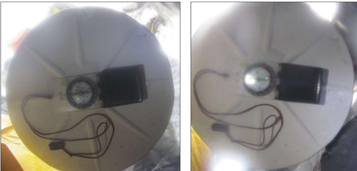
**Figura 21.** Fotografías del proceso de montaje y orientación de la antena GNSS (Ordóñez, 2018).
