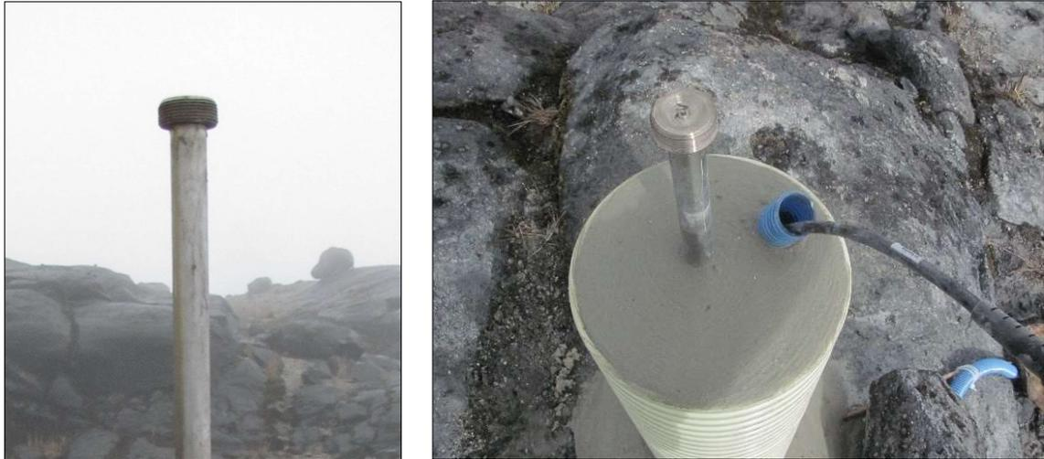
**Figura 18.** Fotografías de la varilla de acero inoxidable y el dispositivo roscado (Ordóñez, 2018).
