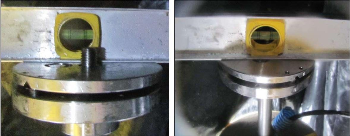
**Figura 20.** Fotografías de la nivelación de la base de acero inoxidable para montaje de la antena GNSS (Ordóñez, 2018).
