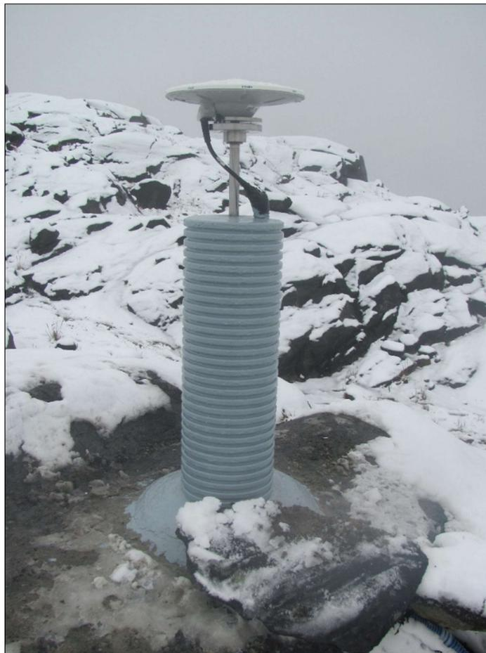
**Figura 23.** Fotografía del mojón de concreto de la estación GNSS (Ordóñez, 2018).
