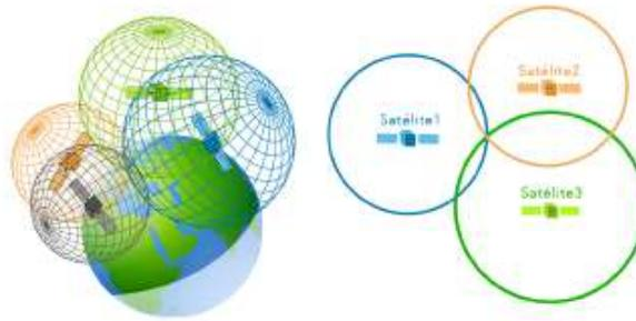
**Figura 6.** Representación de la triangulación para establecer la posición de un receptor.
