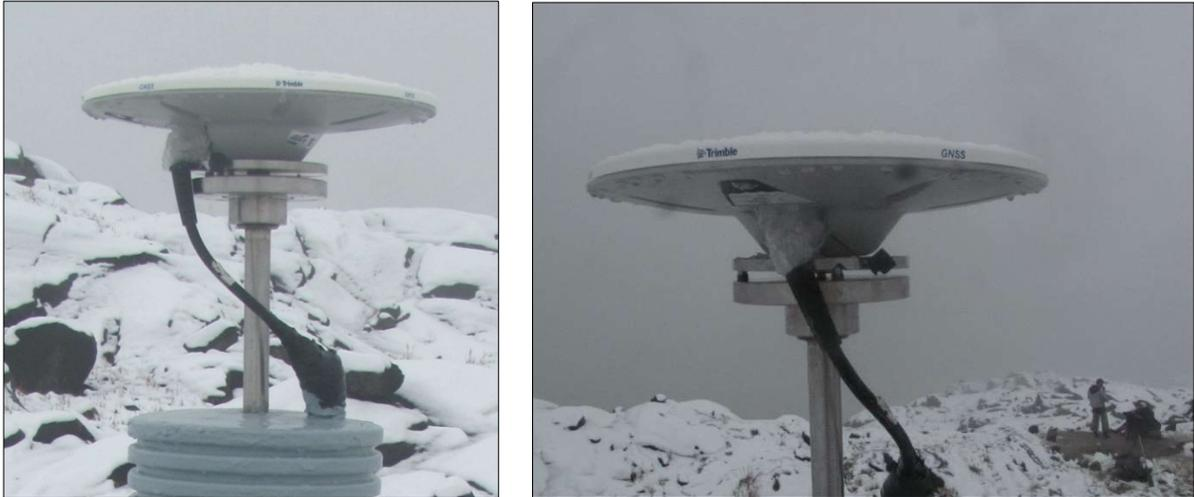
**Figura 22.** Fotografías de la conexión del cable a la antena GNSS y la protección de la manguera (Ordóñez, 2018).
