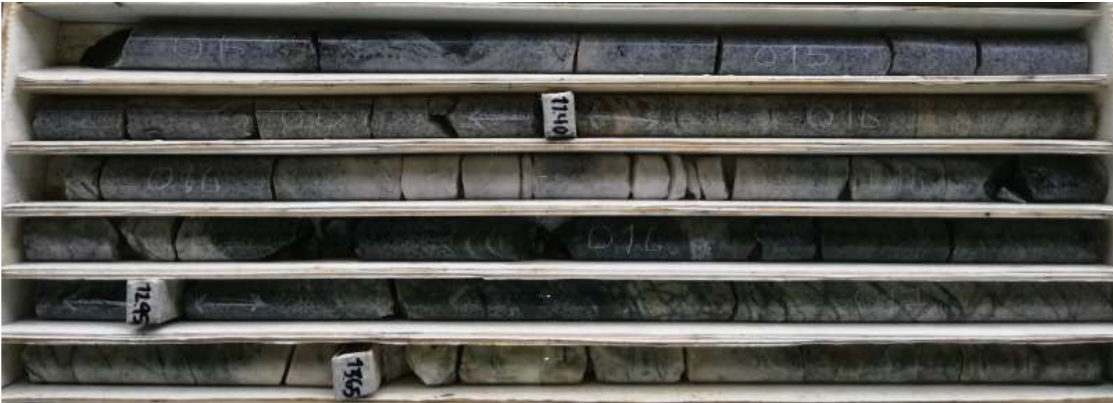
Figura 26. Zona principal. núcleos la zona de cizallamiento y brecha características de la zona del NUS, presentando colores verdosos producto de la cloritización, con presencia de venilleo y vetas.
