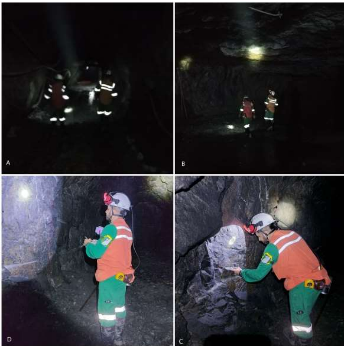
Figura 33. Actividades realizadas en la cartografía subterránea. A) Recorrido de seguridad y verificación de las condiciones de estabilidad donde será realizado el mapeo. B) Revisión rápida de la estructura principal. C) Toma de datos estructurales. D) Descripción geológica detallada.
