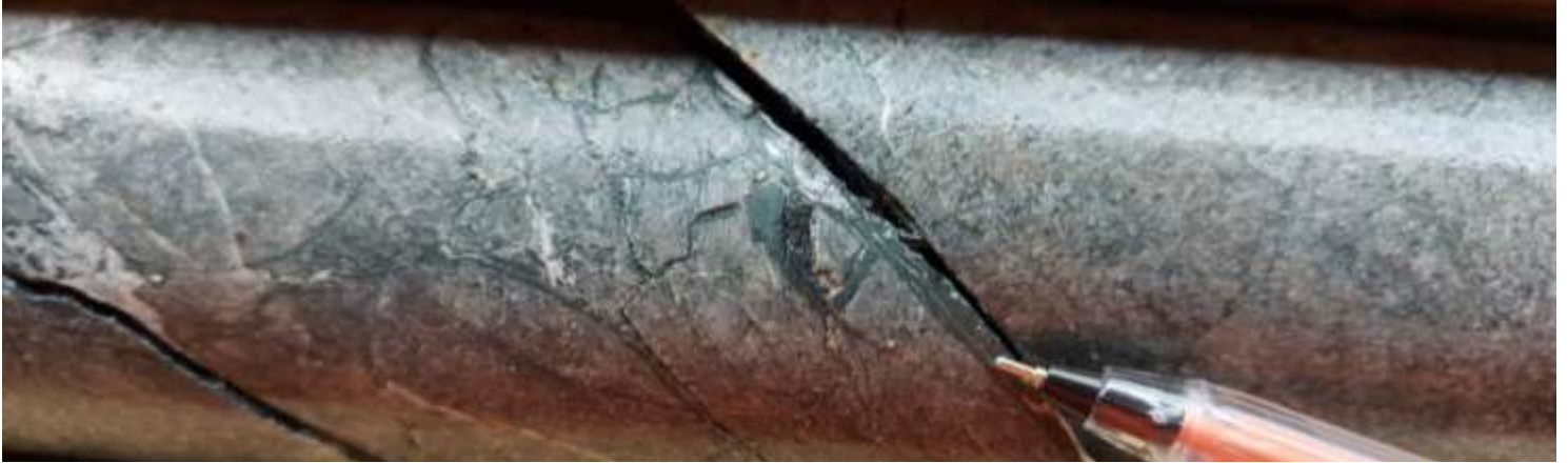
Figura 27. alteración principal. cloritización la cual es definida como la alteración principal de la zona del NUS, ésta presenta estilos pervasivos y relleno de fracturas como se observa en la imagen.
