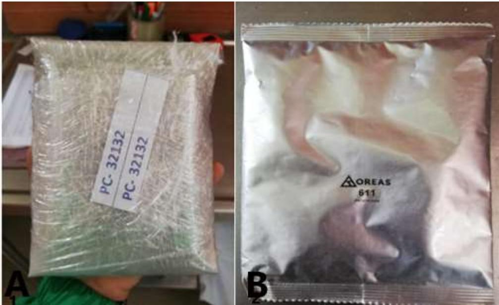
Figura 24. muestras de control. A) blanco fino ya empacado y rotulado. B) estándar específicamente el 611 y la marca del laboratorio certificado.
