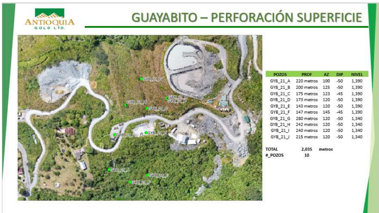
Figura 14. vista en planta del plan de perforaciones Guayabito superficial. obsérvese la tabla con la información de las perforaciones, pozos, profundidad, azimuth, dip y nivel. Imagen tomada de la presentación plan exploración 2021 realizada por el Geólogo Mauricio Marín (jefe de exploración). (Antioquia Gold Ltda, 2017).
