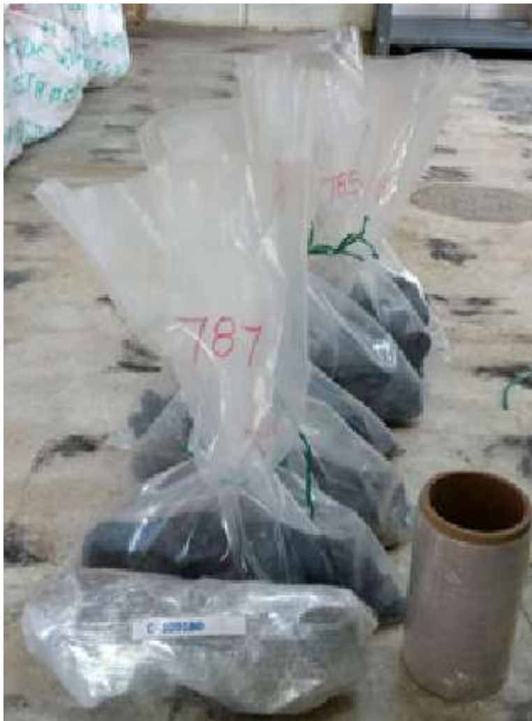
Figura 22. Preparación de muestras embaladas con Film Stretch antes de ser enviadas al laboratorio.
