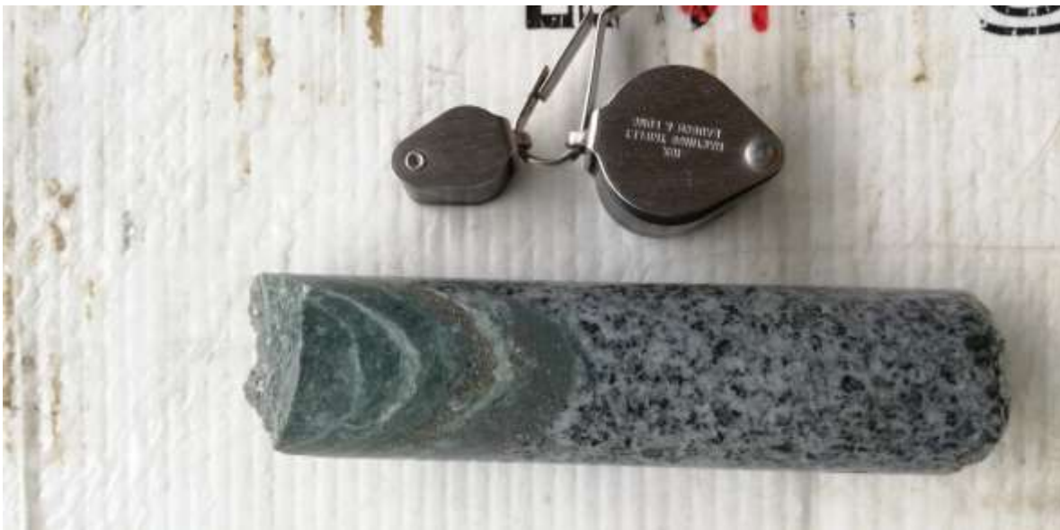
Figura 25. Litología. litología predominante, cuarzdiorita en contacto con la zona de cizalla NUS, reconocible por el color verde producido por alteración propilitica.
