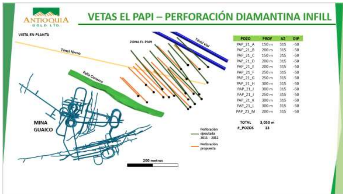
Figura 16. vista en planta del plan de perforaciones Vetas el Papi. donde se puede observar la tabla con la información de las perforaciones, pozos, profundidad, azimuth, dip y costos. Imagen tomada de la presentación plan exploración 2021 realizada por el Geólogo Mauricio Marín (jefe de exploración). (Antioquia Gold Ltda, 2017).
