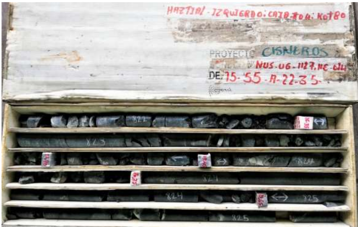
Figura 30. Marcación de muestras. caja indicando la labor donde se realizó la perforación, el hastial, el nivel, código, numero de perforación y el núcleo con sus respectivas marcaciones. Aparecen los 3 últimos dígitos del consecutivo, señalando con flechas el inicio y el fin de cada muestra y con una flecha doble indicando el cambio de muestra.
